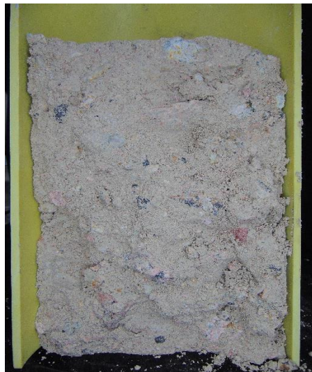
(c) MGM6-C1-Superficie de Falla
