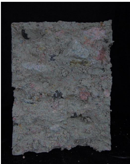
(c) MGM9-C3-Superficie de Falla
