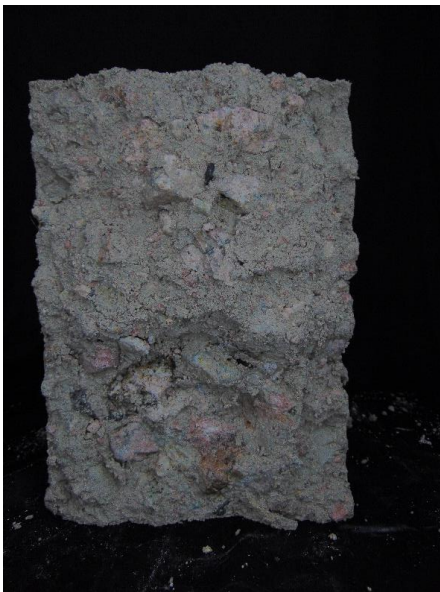
(c) MGM9-C2-Superficie de Falla
