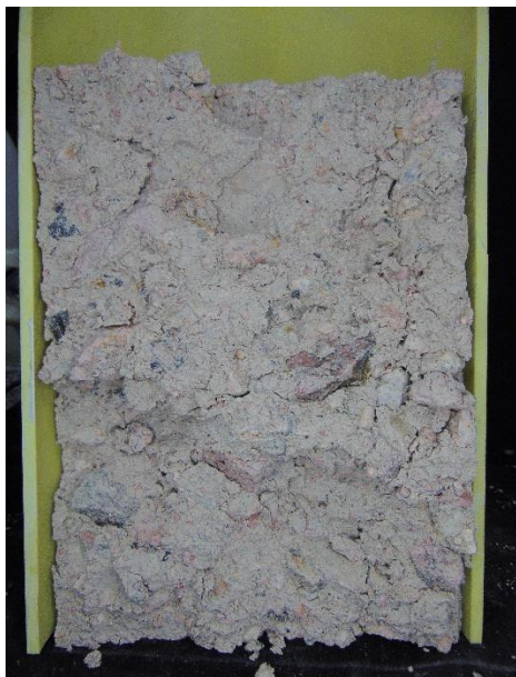
(c) MGM6-C4-Superficie de Falla
