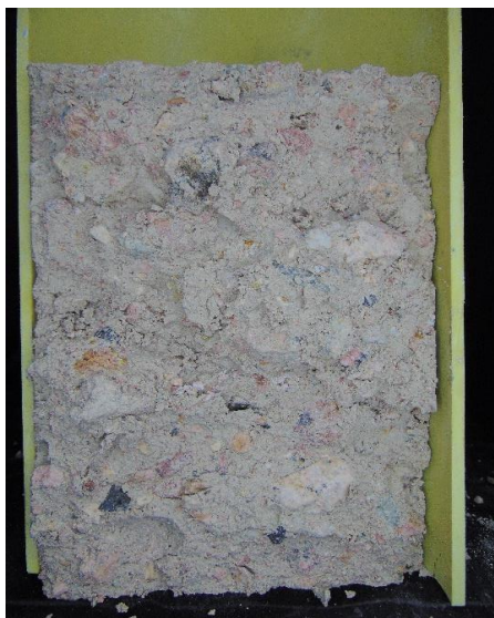
(c) MGM6-C3-Superficie de Falla
