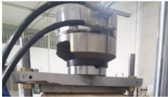
Figura 7. Base de goma transmisión de carga.
