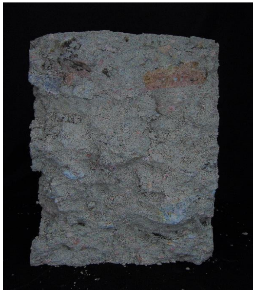
(c) MGM9-C1-Superficie de Falla
