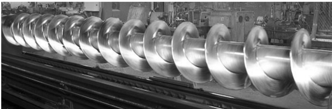
Figura 1 . Trasportador sinfín para la industria alimenticia.
