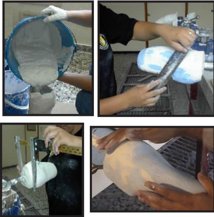
Elaboración del molde positivo, modificación, pulido y rectificación.
