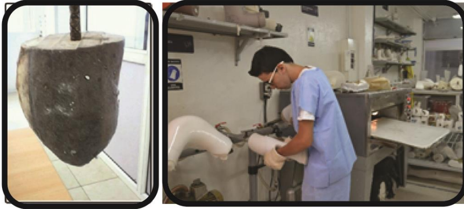
Figura 23 Proceso de termoformado
