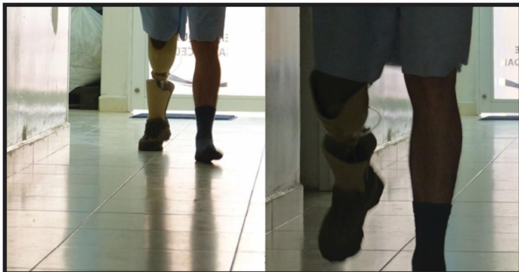
Figura 35 Prueba de alineación dinámica. Marcha del paciente.
