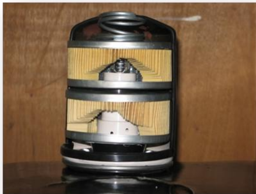
Ilustración 16. Corte de filtro dual ensamblado
