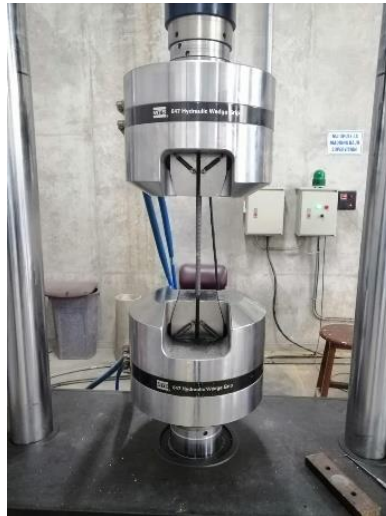
Ilustración 8. Probeta de 3/8" luego del ensayo a tracción.
