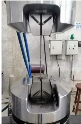
Ilustración 9. Probeta de 1/4" luego del ensayo a tracción.
