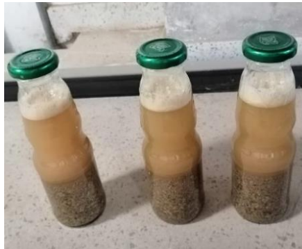
Ilustración 6. Muestras del ensayo de impurezas orgánicas después de ser agitadas.
