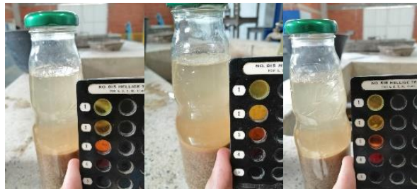
Ilustración 7. Muestras del ensayo de impurezas orgánicas comparadas con los vidrios de color estándar.
