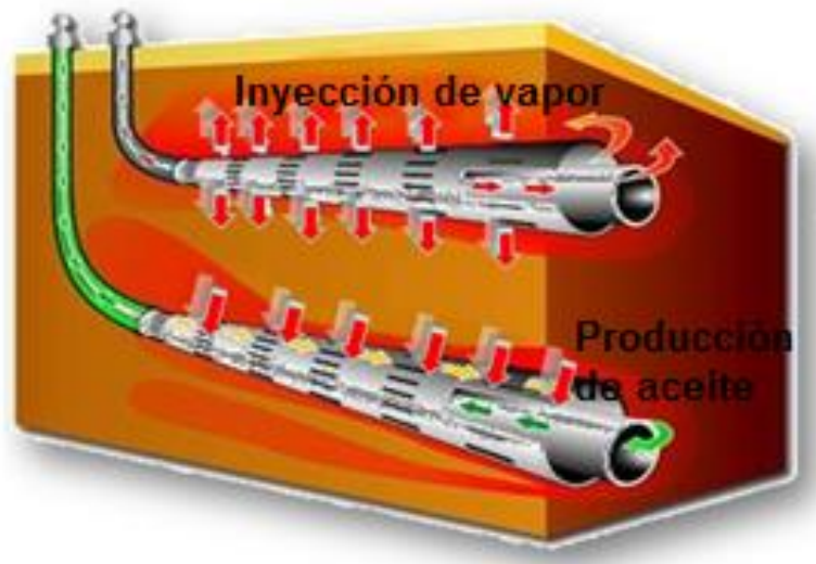
Figura 1. Configuración de un proceso SAGD.
