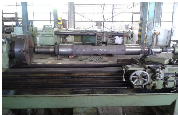
Figura 10. Torno convencional, prueba de excentricidad.
