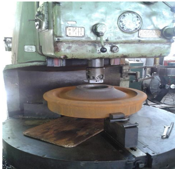
Figura 5. Barrenado de ruedas
