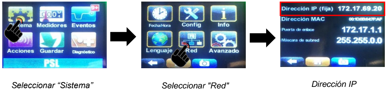
Figura B.1. Descripción grafica del procedimiento para encontrar la dirección IP del dispositivo de medición PQube3.
