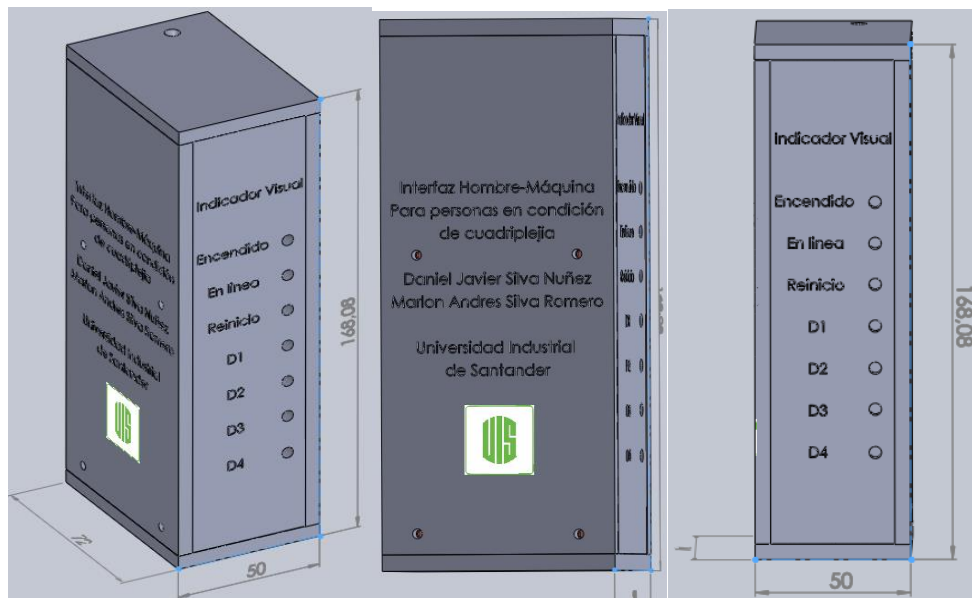
Figura 44. Chasis de la tarjeta emisora con sus respectivas medidas
