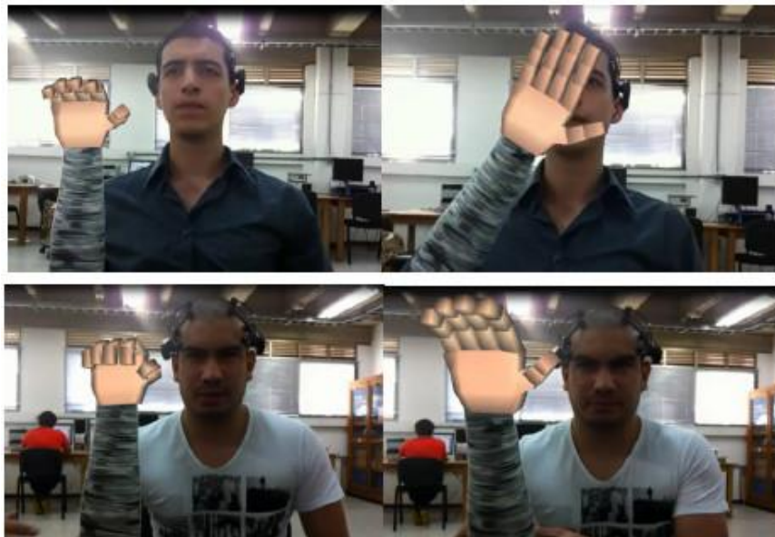
Figura 10. Sistema BCI para rehabilitación del síndrome de miembro fantasma
