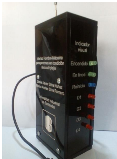
Figura 45. Resultado final del Chasis de la tarjeta transmisora
