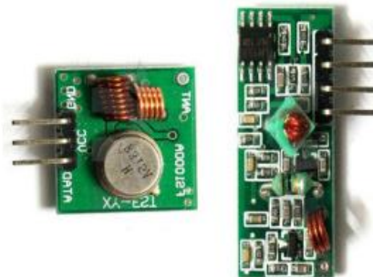
Figura 34. Módulos emisor XY-FST y receptor XY-MK-5V de radiofrecuencia
