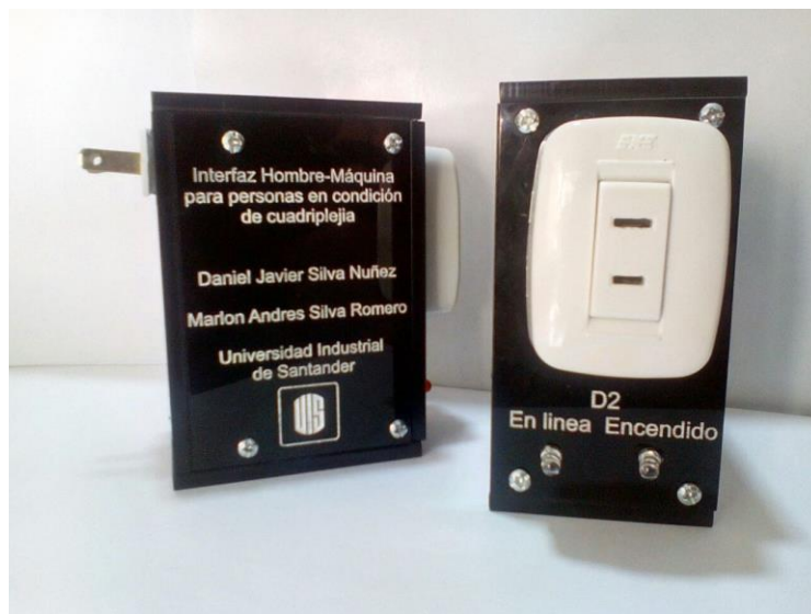
Figura 49. Resultado final del chasis usado para los módulos receptores
