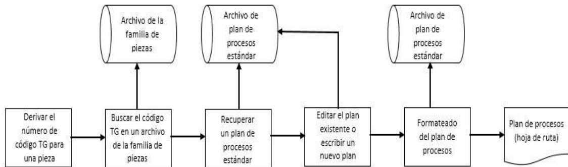
Figura 69. Funcionamiento de un CAPP de tipo recuperativo
