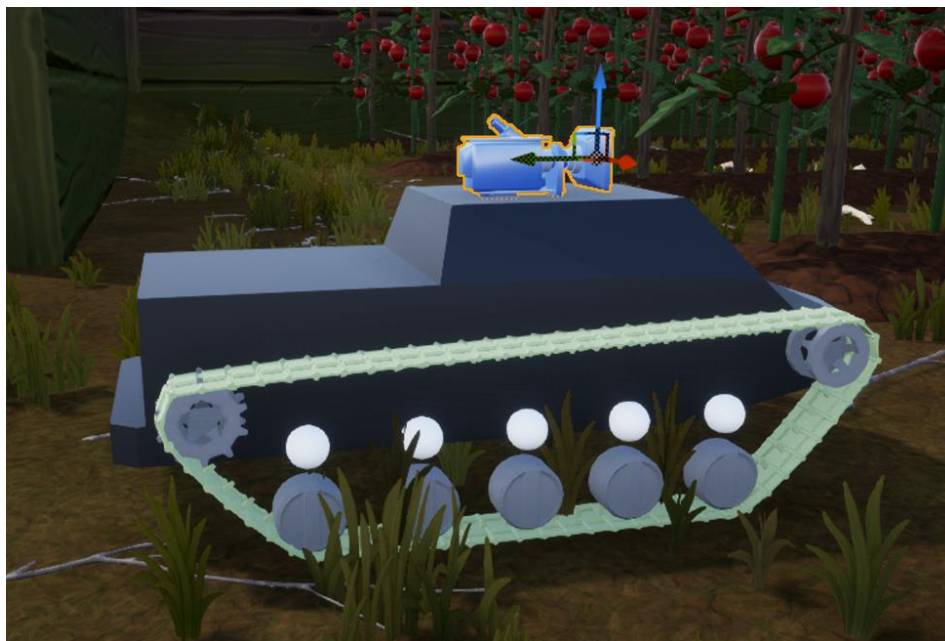
Figura 45. Implementación del sensor LiDAR en Unreal Engine. Fuente: Autor.
