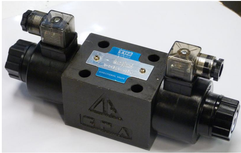
Fig. 46 Válvula direccional CETOP 5 de tres posiciones cuatro vías centro punto flotante accionada por solenoide marca TDZ.
