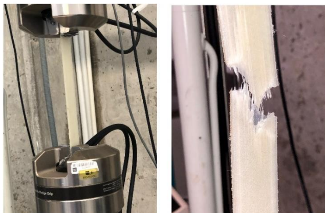
Figura 8. (a) Fotografía de la muestra en máquina de ensayo. (b) Fotografía de la fractura de la muestra.
