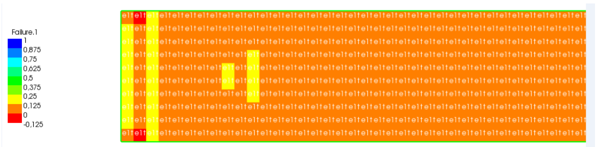
Figura 11. Criterios de falla probeta ASTM
