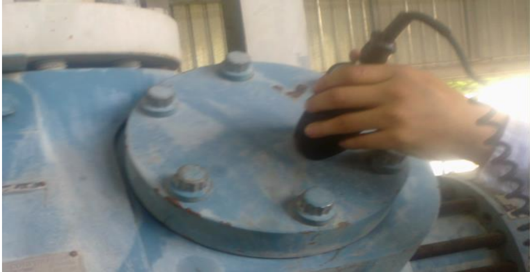
Figura 28. Ultrasonido válvula Compresoras Reciprocantes.
