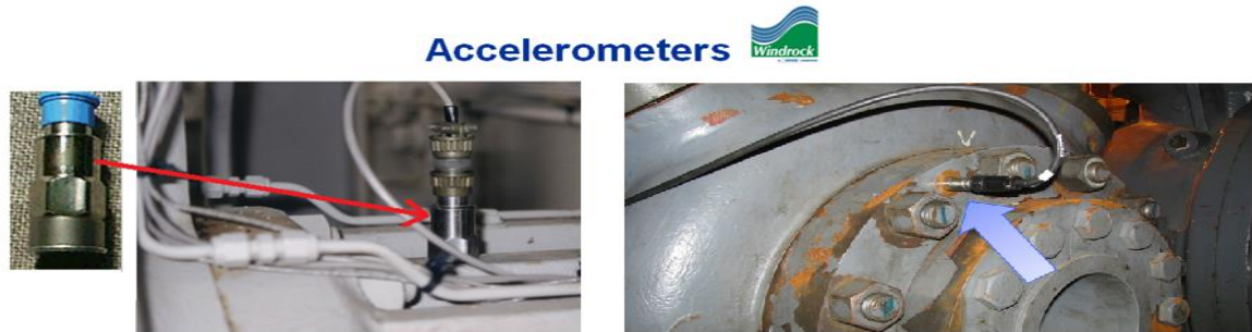
Figura 50. Instalación del acelerómetro en cilindros de compresores recíprocos.
