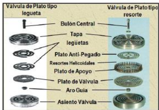
Figura 19. Válvulas tipo Lengua y Resorte.
