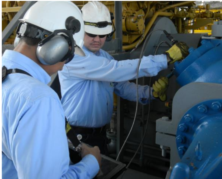
Figura 26. Análisis de vibraciones en válvulas de compresores reciprocantes
