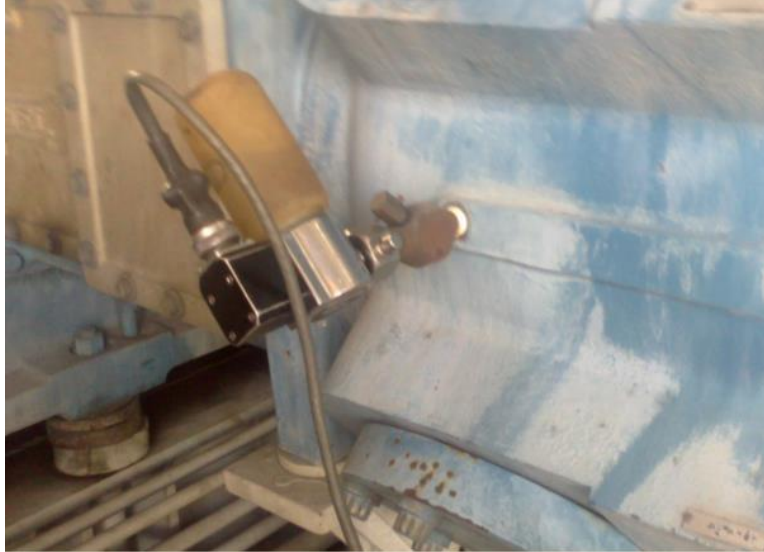
Figura 27. Medición de presiones de cilindros compresores reciprocantes.
