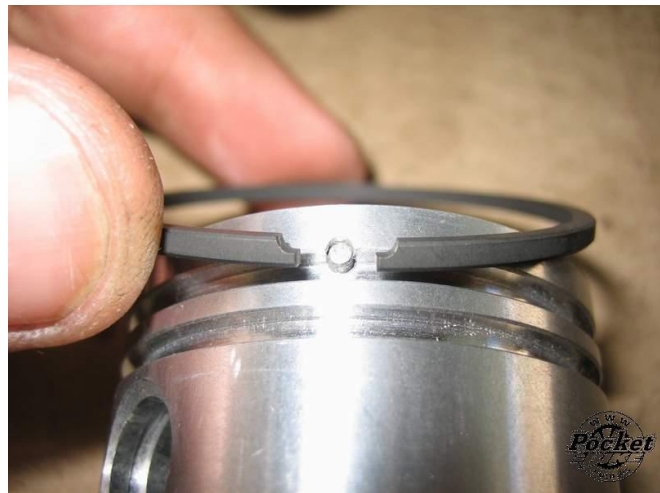
Fig. 2. Detalle de los segmentos y el pistón.
