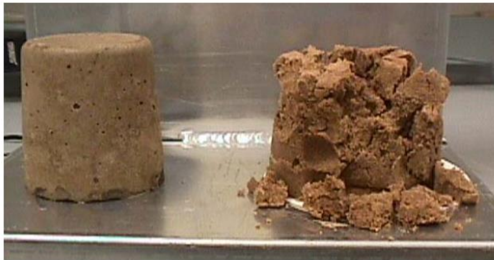
Figura 24: Núcleo de piedra arenisca suelta "solidificado" utilizando material monómero.
