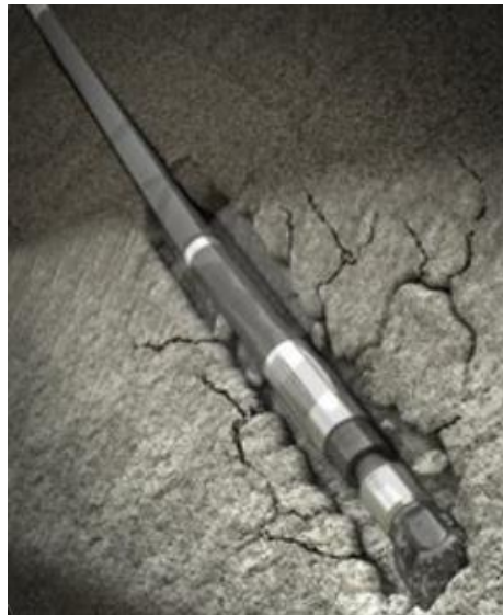
Figura 19: Pérdidas de circulación durante la perforación
