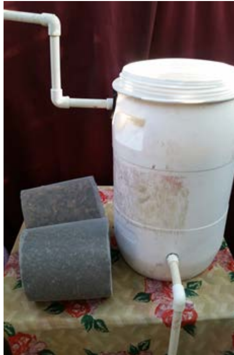
Figura 39. Lechos filtrantes alternativa 2 y 3
