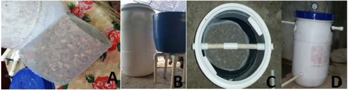
A) Malla de acero inoxidable en forma de caja B) Soporte para la estabilidad del filtro C) Vista superior de la configuración interna D) recipiente sellado y listo para trabajar.
