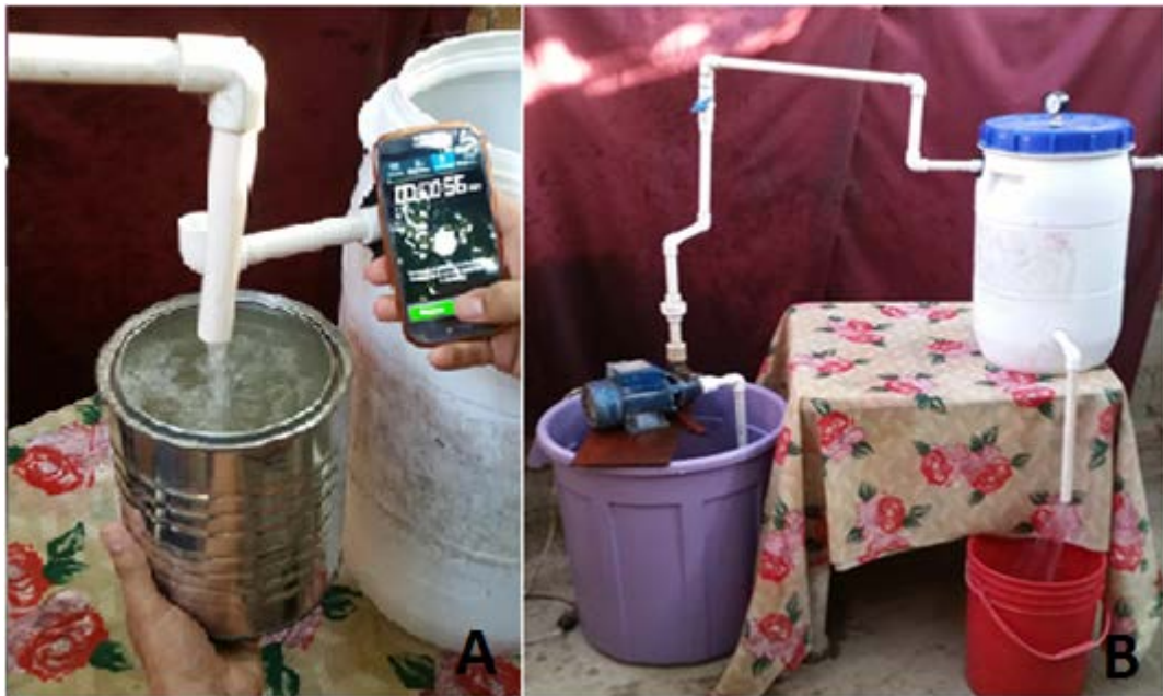
A) Medición del flujo de trabajo B) Esquema de filtración alternativa 2
