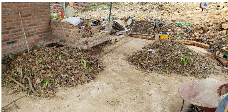
Fotografía F5. Segundo cuarteo y selección de los 50 Kg de muestra
