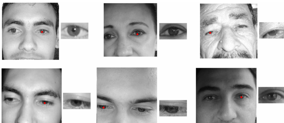
Figura 19. Ejemplos de detección del iris y segmentación del ojo
