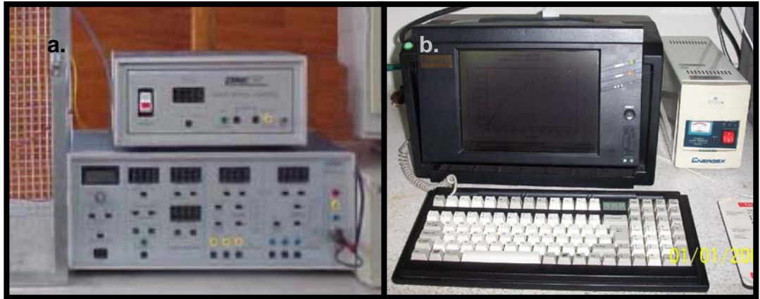
Figura 4.7. Equipos empleados para la realización de lo ensayos electroquímicos (a.) Bipotenciostato Pine AFCEBP1;(b.) Potenciostato GAMRY
