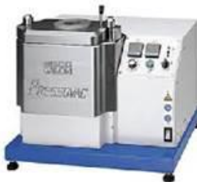
Figura 33. Máquina de fundición con atmósfera controlada. Adaptado de http://www.tecnijoy.net/product_info.php?products_id=1558
