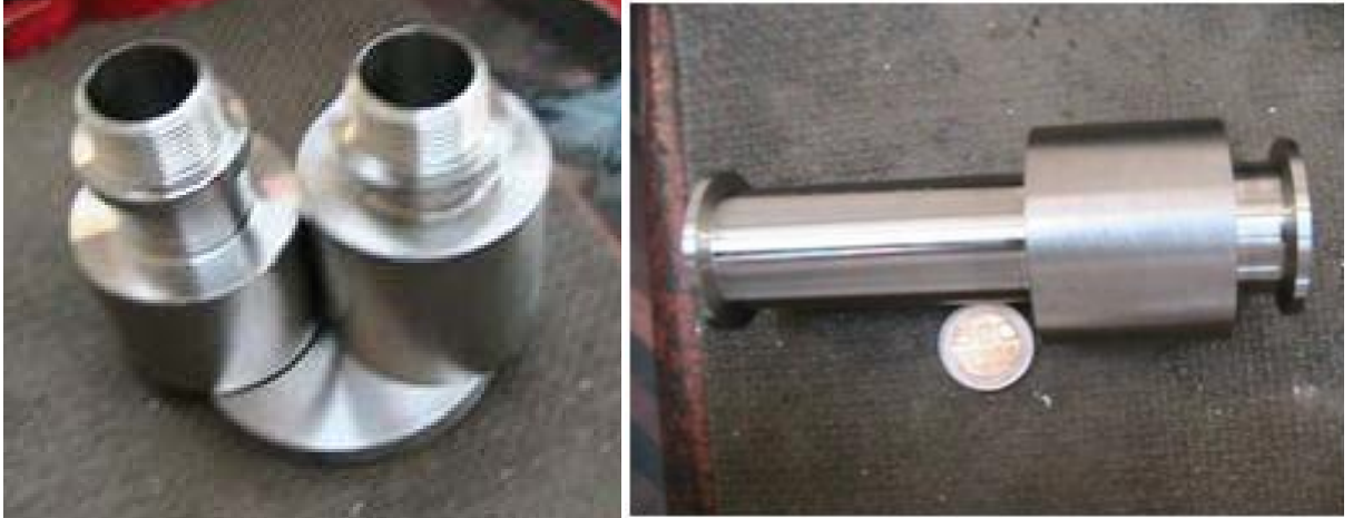
Figura 49. Montaje ¾ in en construcción
