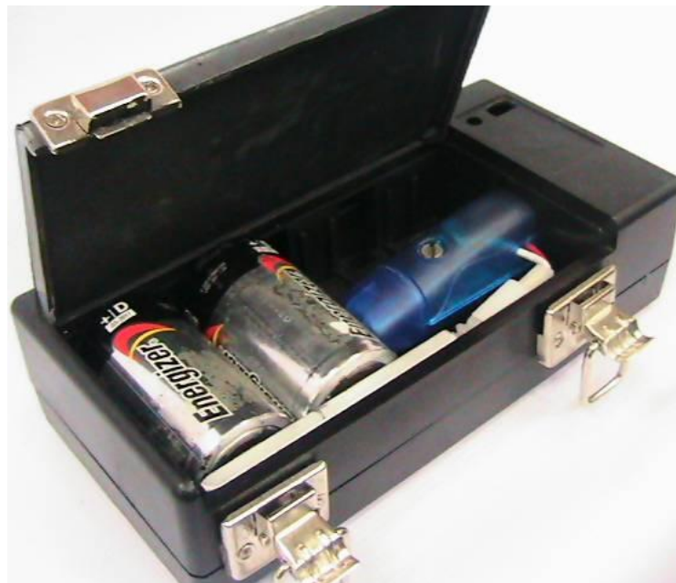
Figura 59. Dispositivo final acelerómetro, nueva fuente de alimentación
