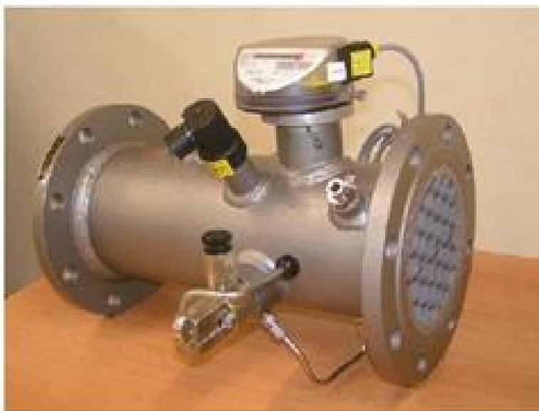
Figura 30. Dispositivo de transferencia COOMET B
