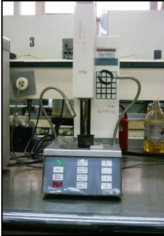
Equipo utilizado para realizar prueba de penetración
