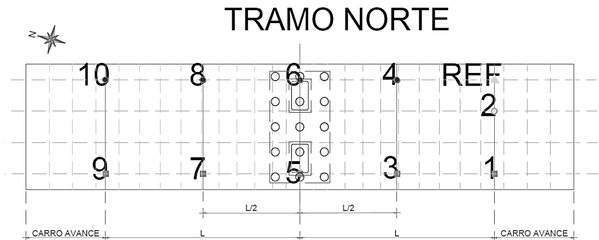
Figura 16. Ubicación de sensores Tramo norte – Tramo Sur
