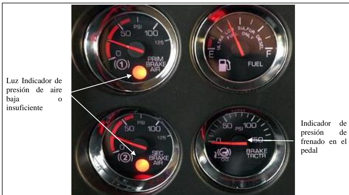
Reloj indicador de presión de aire disponible y presión ejercida sobre pedal de freno
