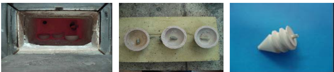
Figura 14. Proceso de cristalización térmica de tornillos de Ti6Al4V recubiertos con fosfato de calcio por el proceso de APQ
