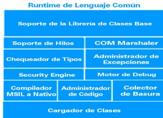
Estructura del CRL
