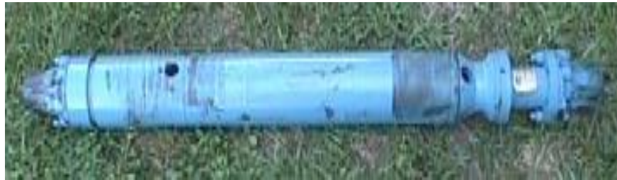
Figura 9. Separador de gas
