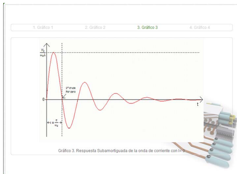
Figura 41. Representación gráfica de la respuesta subamortiguada en Circuitos Eléctricos.
