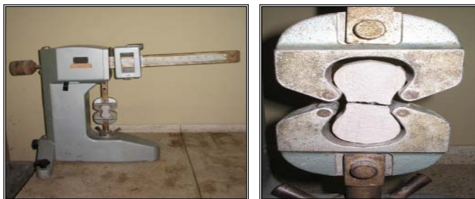
Figura 5. Montaje ensayo de tracción
