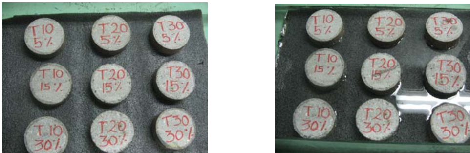
Figura 8. Montaje ensayo absorción capilar
