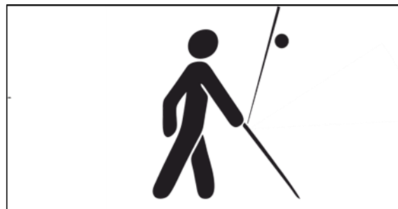
Figura 35. Detección de objetos a diferentes alturas mediante el sensor de infrarrojo.
