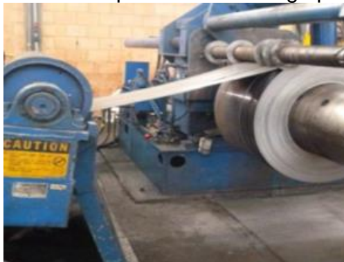
Figura 27. Tensionador para evitar el riesgo para el operario
