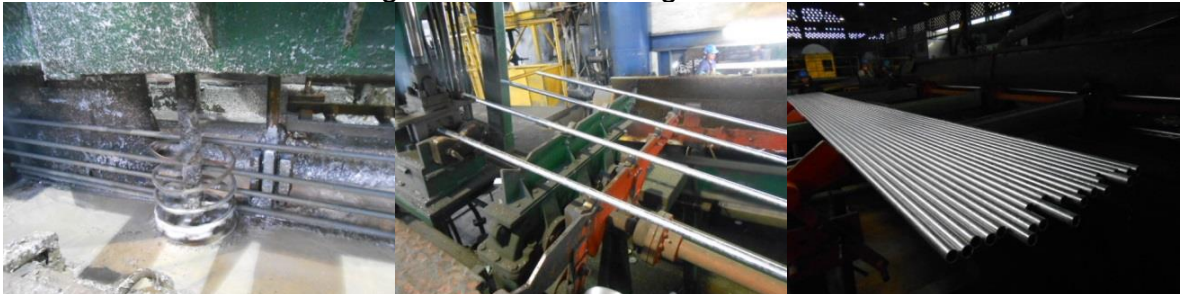
Figura 8. Proceso de galvanizado
