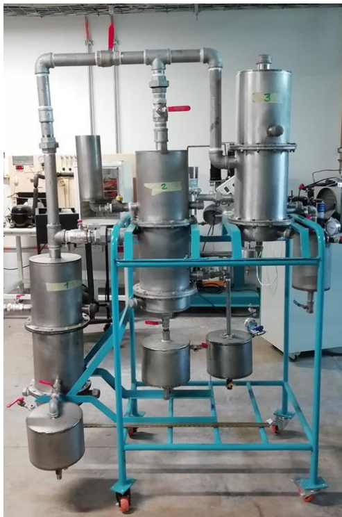
Figura 18. Montaje de conexiones de tubería entre tanques e intercambiadores.
