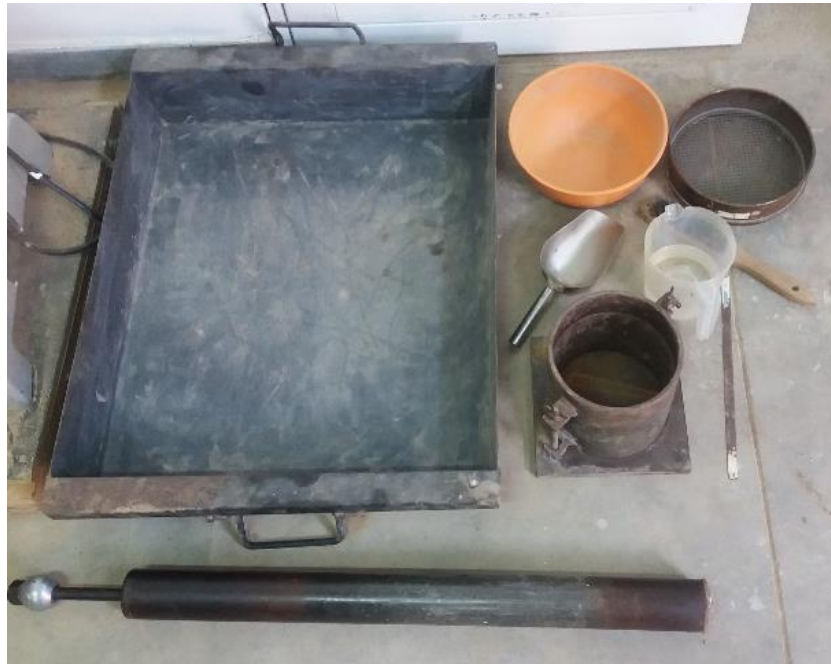
Figura 3: Materiales usados para el ensayo de Proctor Modificado
