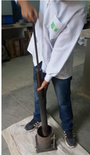
Figura 4: Proceso de Compactación
