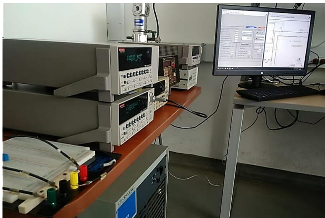
Figura 13. Montaje para medir resistividad eléctrica a partir del método de van der Pauw.
