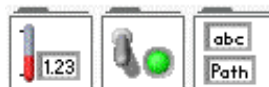
Figura 9. De izquierda a derecha: Controles e indicadores numéricos, booleanos y de cadena de caracteres.
