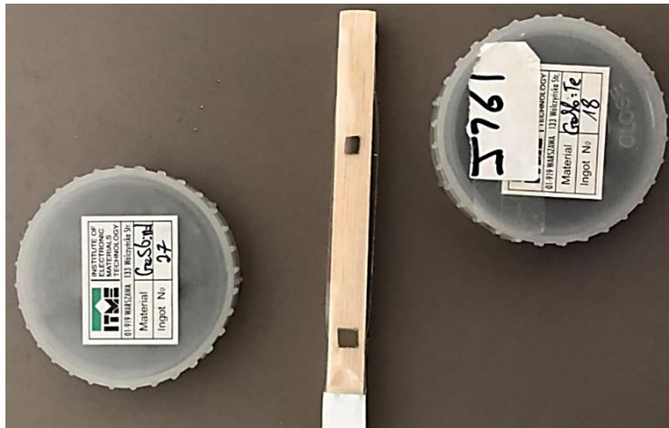
Figura 17. Ubicación de las láminas semiconductoras de GaSb sobre un soporte de madera
