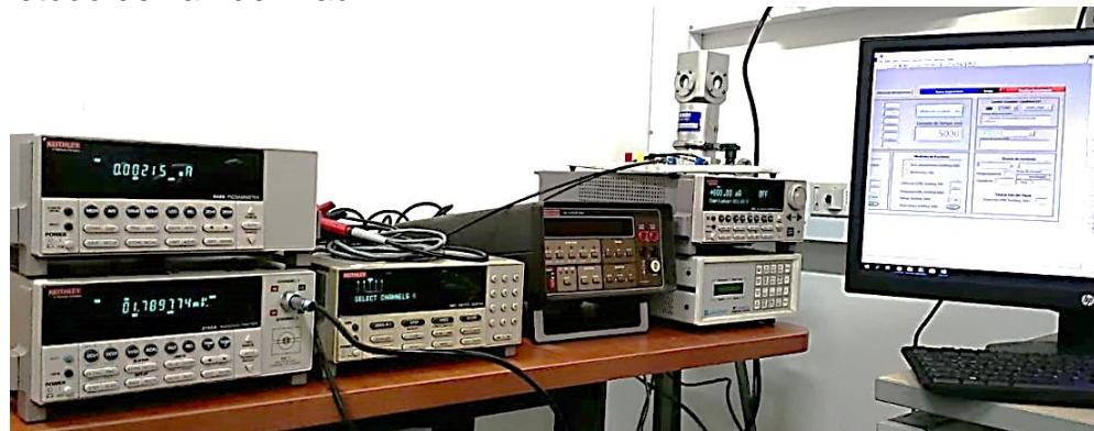
Figura 16. Montaje para medir resistencia eléctrica a un circuito de prueba a partir del método de van der Pauw.
