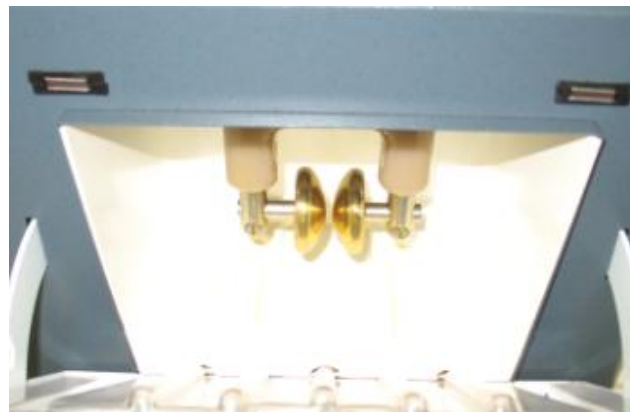
Figura 3.6: Detalle electrodos tipo disco Fuente: Autores del proyecto
