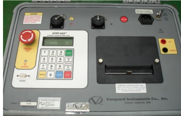
Figura 2.1: Equipo para medir la relación de transformación (TTR). Fuente: Autores del proyecto
