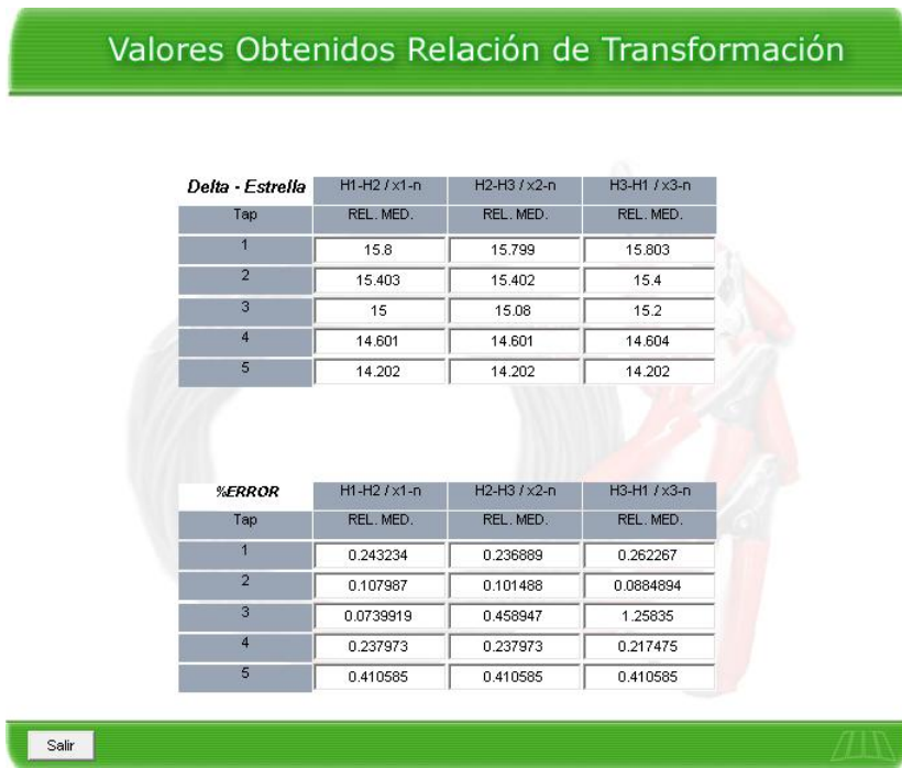
Figura A.9: Resultados de la prueba de Relación de transformación
