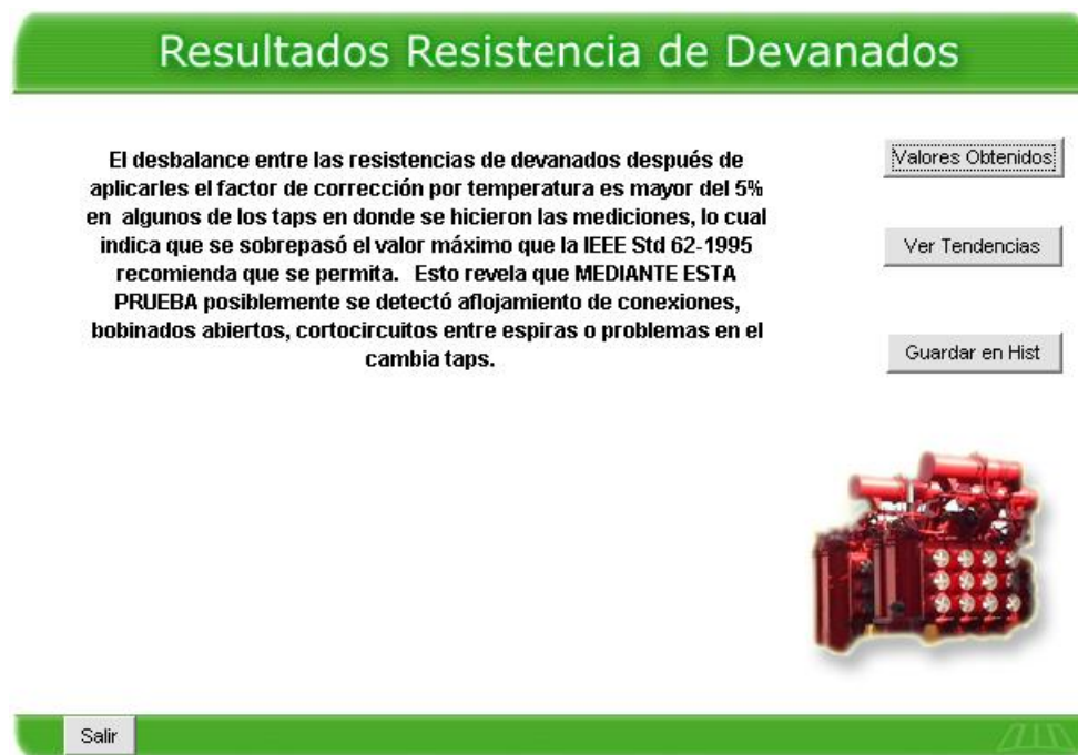
Figura 5.9: Análisis individual prueba de Resistencia de devanados
