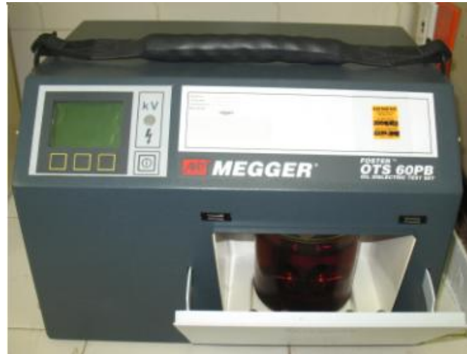
Figura 3.5: Medidor de tensión de ruptura dieléctrica con electrodos tipo disco Fuente: Autores del proyecto
