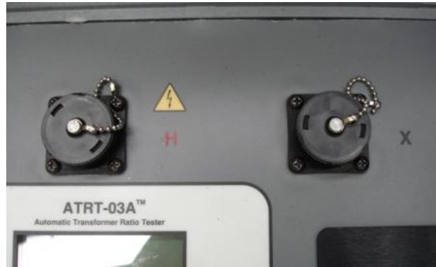
Figura 2.3: Terminales para conexión de los grupos de puntas en el TTR Fuente: Autores del proyecto
