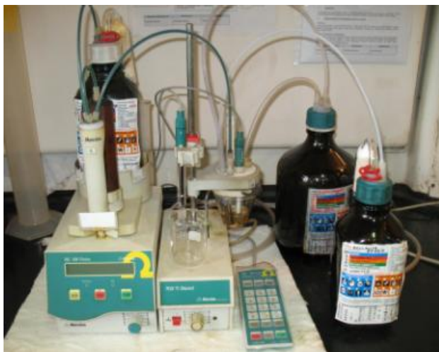
Figura 3.4: Equipo de laboratorio para medir el número de neutralización Fuente: Autores del proyecto
