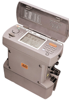
Figura 2.4: Óhmetro digital de baja resistencia
