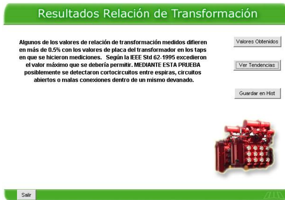
Figura A.8: Análisis de los resultados de la prueba de Relación de transformación
