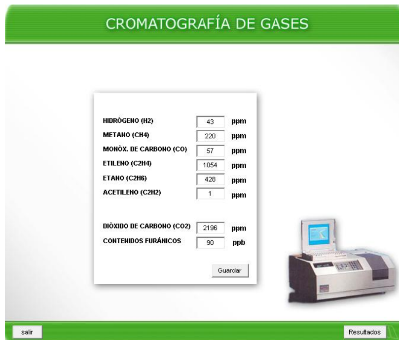
Figura 5.7: Resultados de cromatografía de gases
