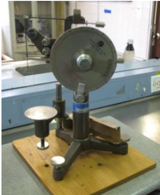
Figura 3.3: Tensiómetro de precisión Fuente: Autores del proyecto
