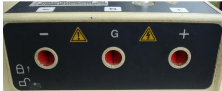
Figura 2.9: Terminales megóhmetro Fuente: Autores del proyecto
