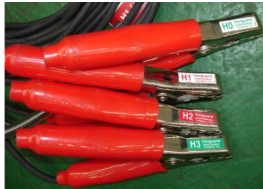
Figura 2.2: Terminales señalizadas para los devanados de alta tensión en un TTR trifásico Fuente: Autores del proyecto
