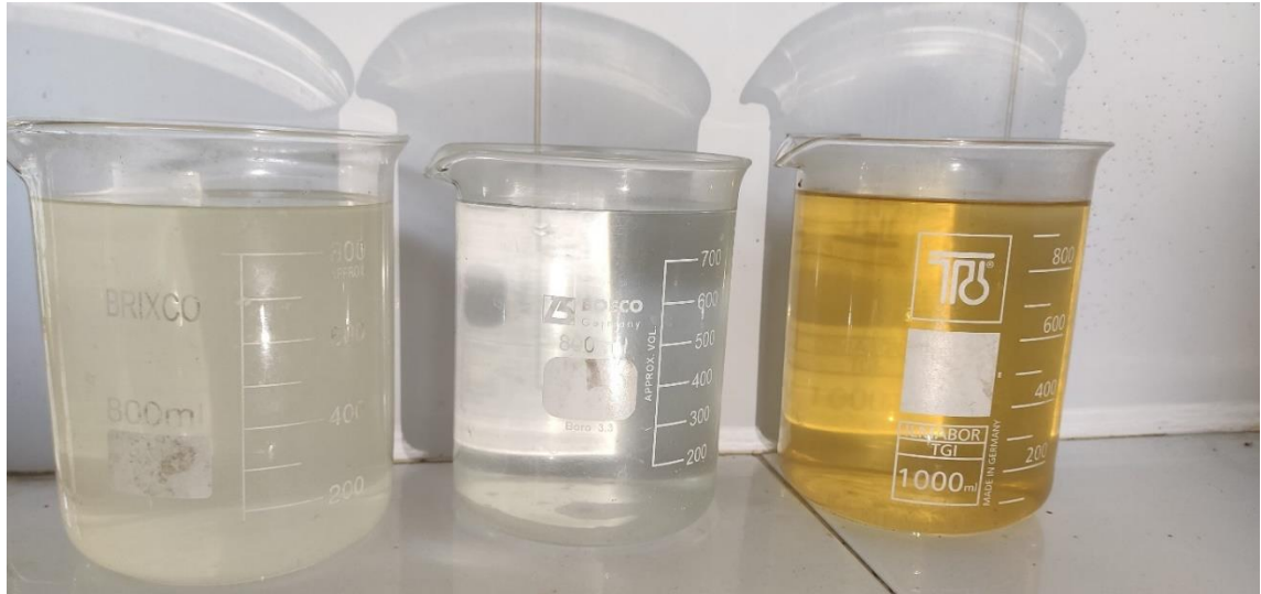
Figura 61. Efluente de la PTAR, el destilado producido por el sistema y los lodos concentrados.
