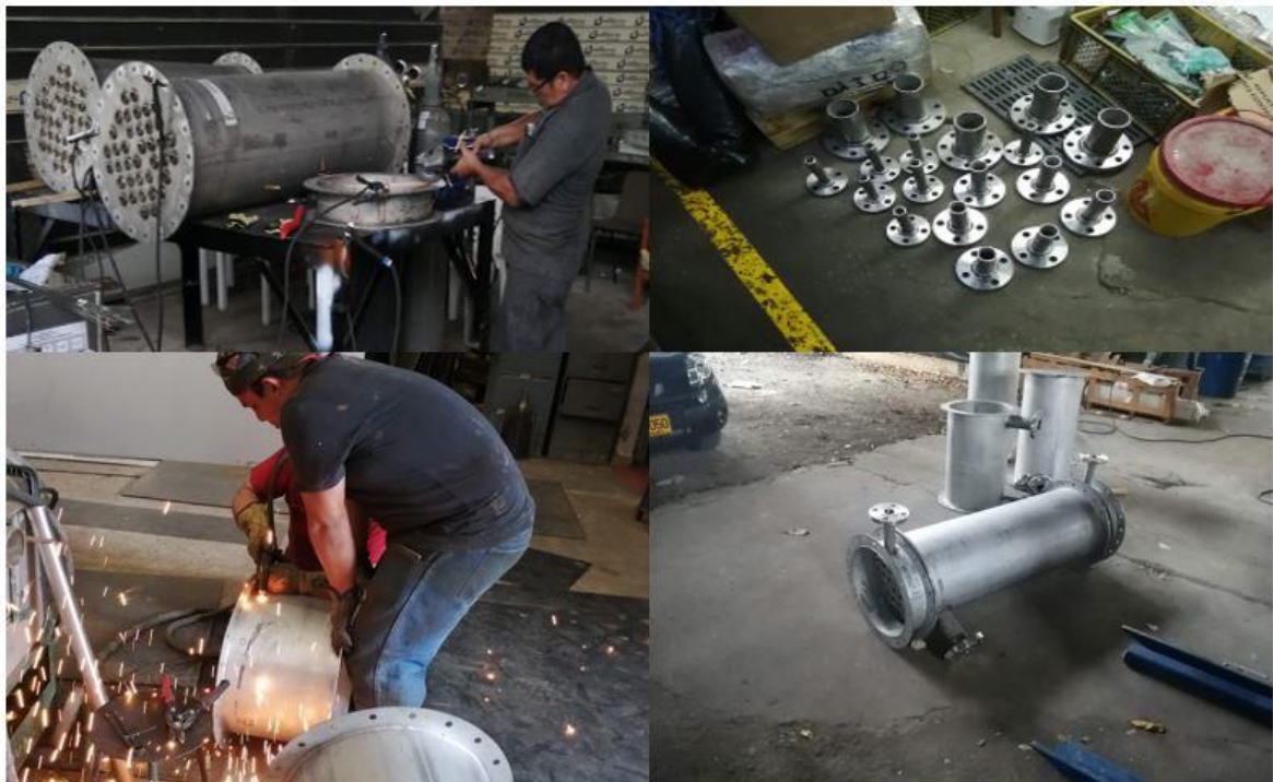
Figura 31. Proceso de soldadura de equipos y bridas de unión.
