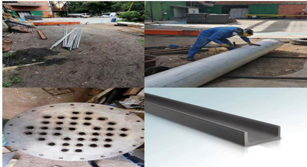
Figura 29. Materiales usados para construcción de Evaporadores y Condensador.
