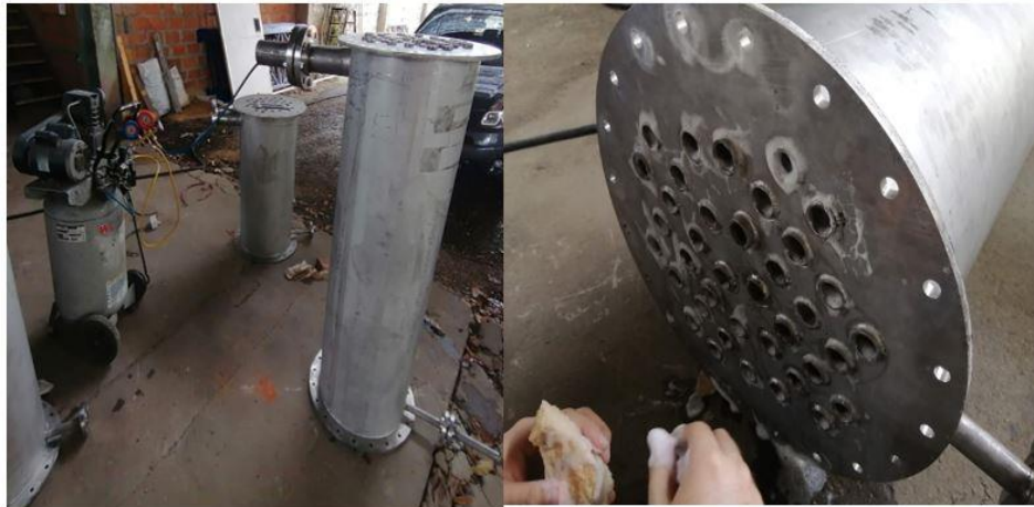
Figura 32. Pruebas de hermeticidad para cascos de los equipos.
