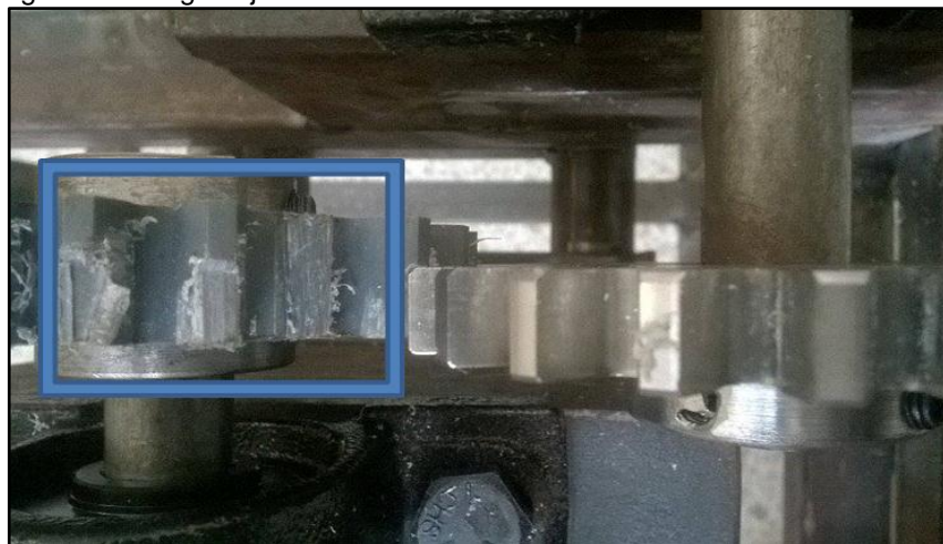
Figura 80. Desgaste del engranaje.
