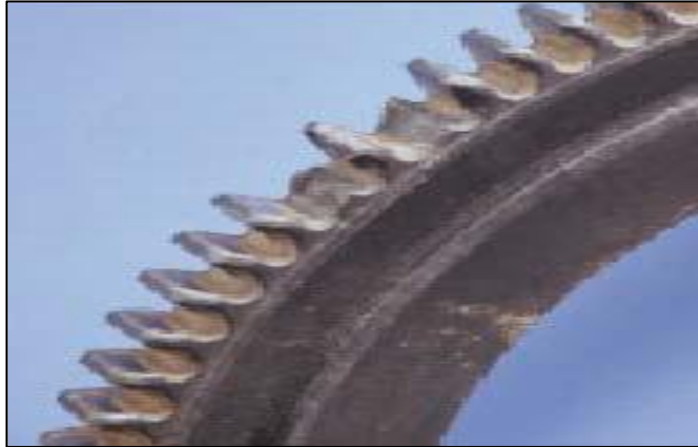
Figura 13. Fractura del diente.
