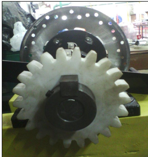
Figura 4. Instalación de engranaje de prueba.
