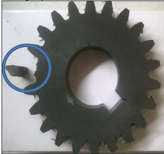
Figura 79. Rotura de diente engranaje PVC.
