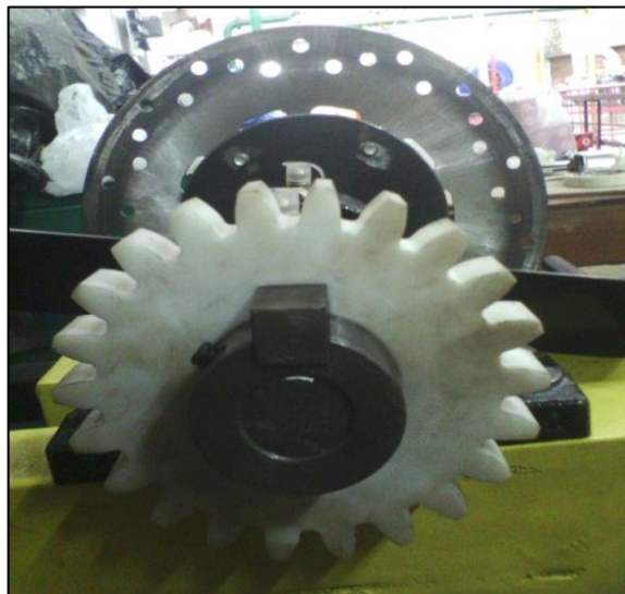
Figura 4. Instalación de engranaje de prueba.
