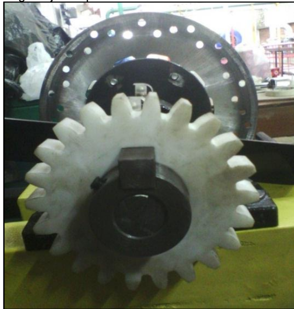
Figura 77. Instalación de engranaje de prueba.
