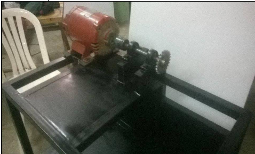
Figura 69. Instalación eje conductor.
