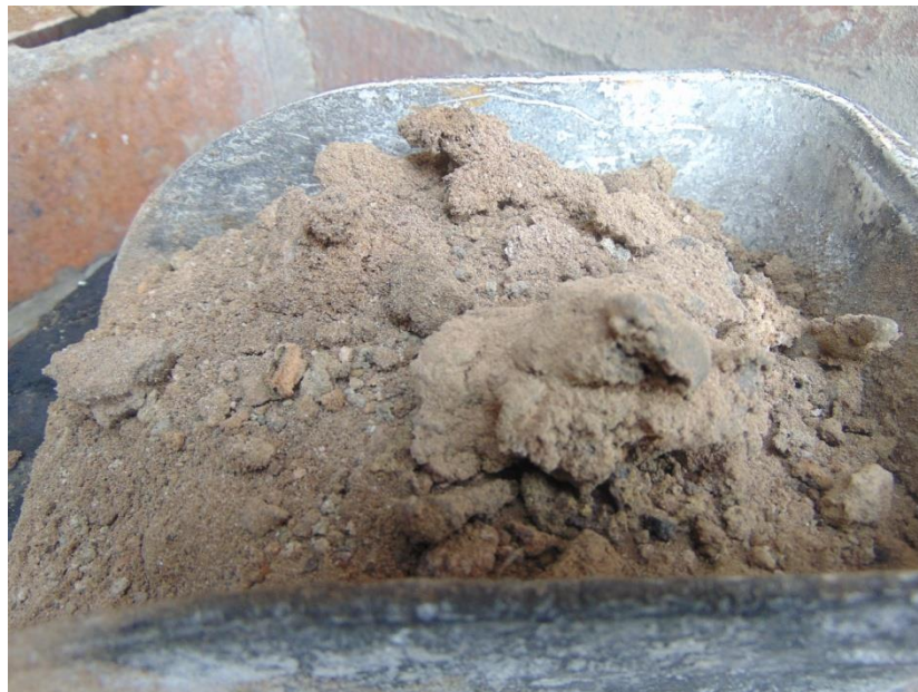
Figura 5. Material particulado captado en sedimentador vertical vía húmeda
