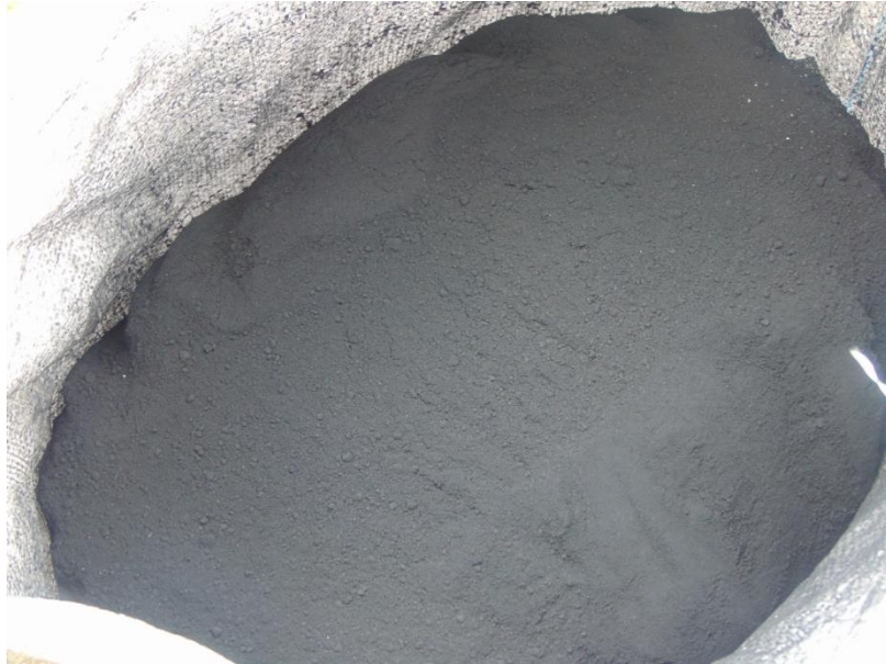
Figura 10. Material particulado captado en filtro de mangas vía seca
