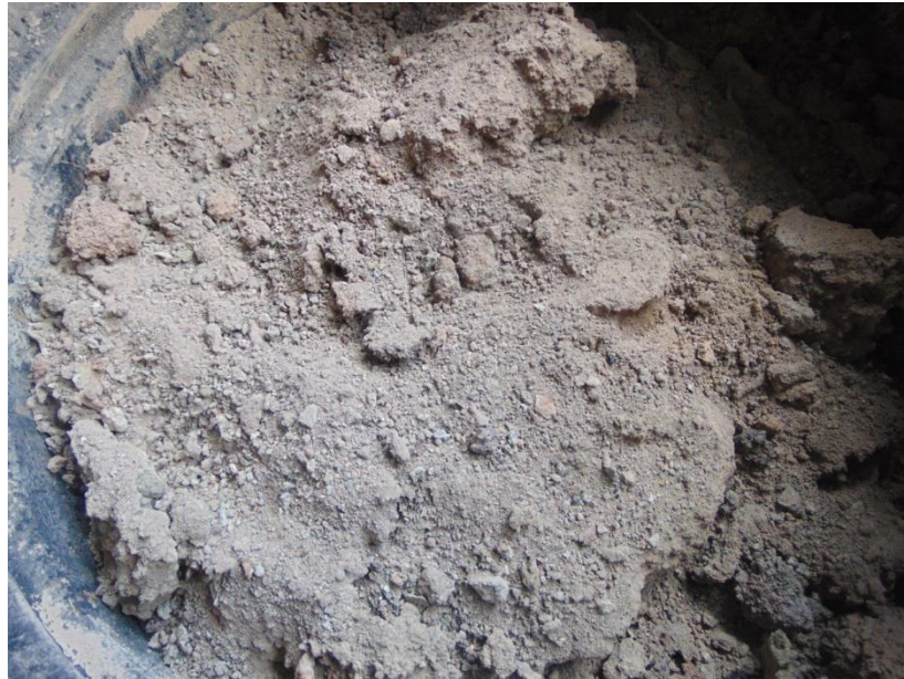
Figura 8. Material particulado captado en sedimentador ciclónico vía seca
