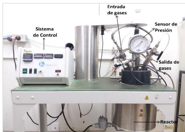
Figura 3. Reactor tipo Batch autoclave dinámico Parr 4848
