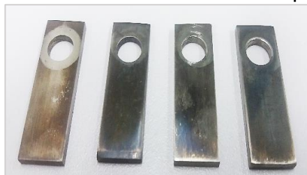
Figura 4. Cupones gravimétricos de acero AISI 316 expuestos a 24, 36, 48 y 60 h.
