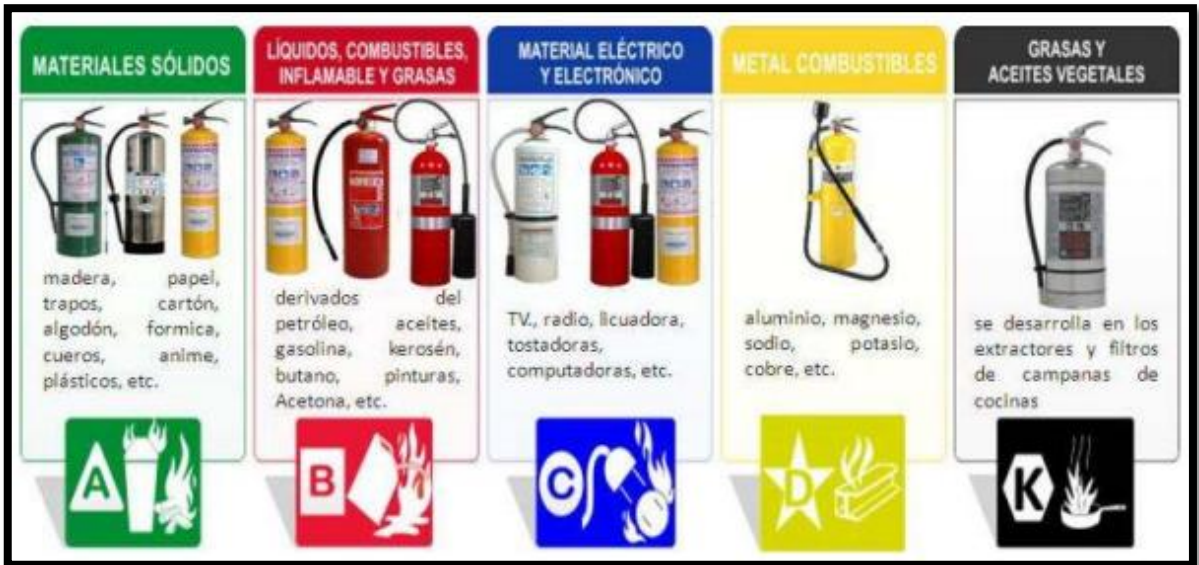
Figura 2. Extintores portátiles de incendio
