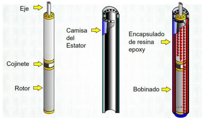
Figura 31 Componentes del motor
