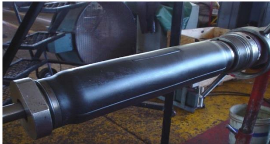
Figura 36 Protector de Cámara laberíntica
