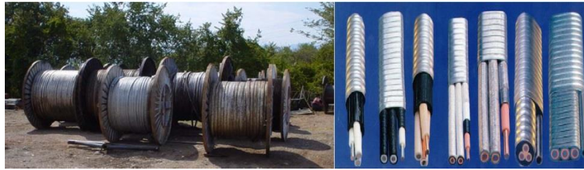
Figura 34 Cable de potencia
