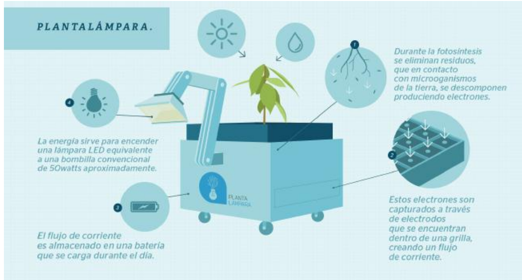
Figura 26. Funcionamiento de la lámpara
