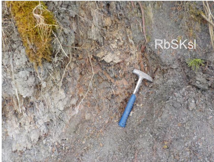
Fotografía 27. Vista de Trinchera al SW, margen izquierda aguas abajo sobre el Rio Charta, en la que se aprecia, roca blanda saprolitizada de la Formación la Luna.
