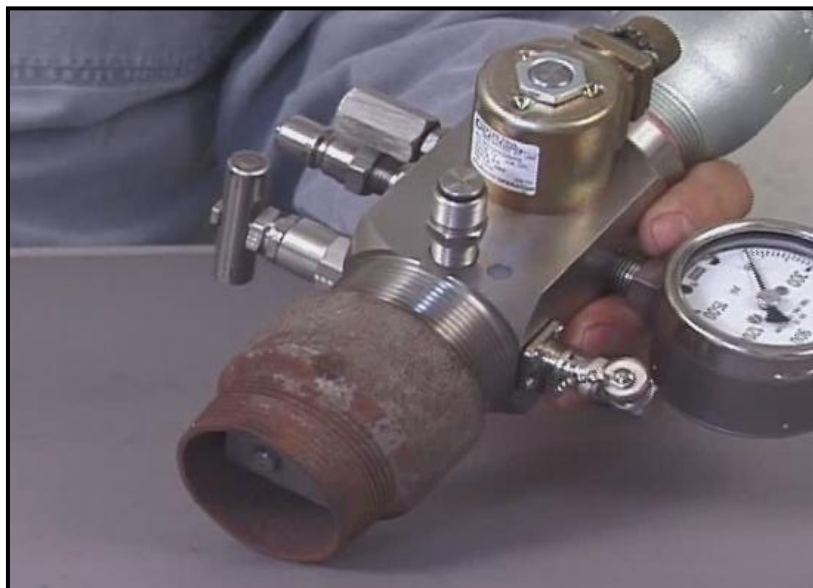
Figura 154. Imagen de la rosca del Protector del micrófono de la pistola completamente oxidada
