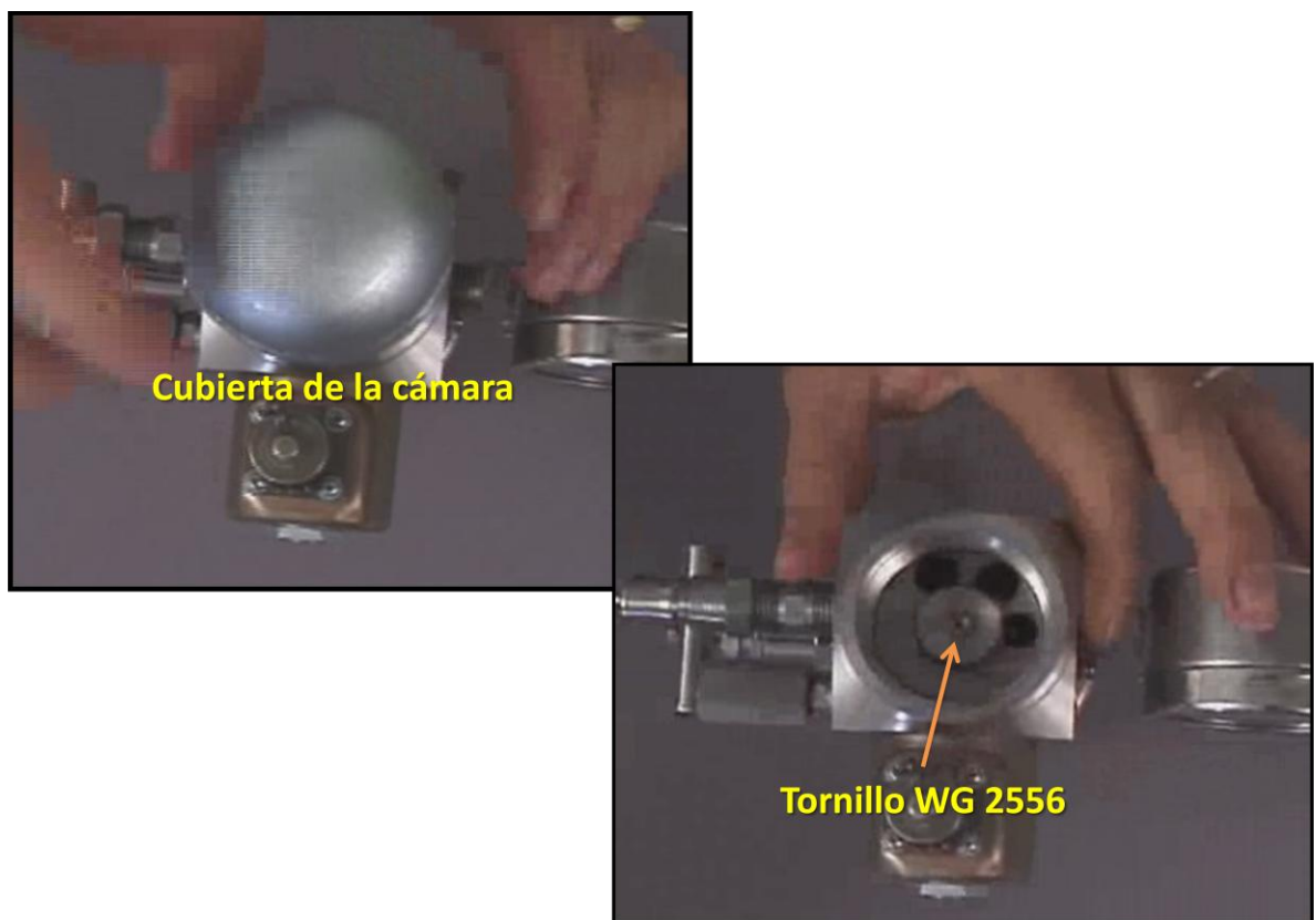
Figura 165. Imagen del procedimiento de extracción de la válvula de gas
