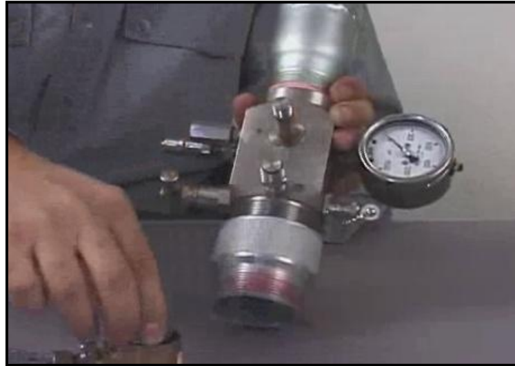
Figura 158. Imagen del retiro de la coraza del solenoide
