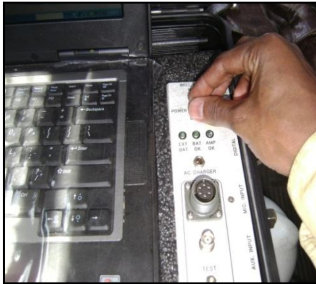
Figura 62. Encendiendo el analizador de pozos
