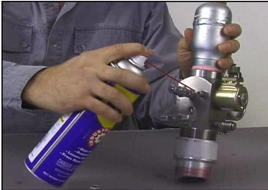
Figura 174. Imagen de la limpieza de la válvula de carga de gas
