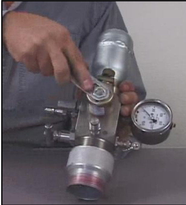
Figura 157. Ilustración del modo de desenroscar la tuerca de la coraza del solenoide
