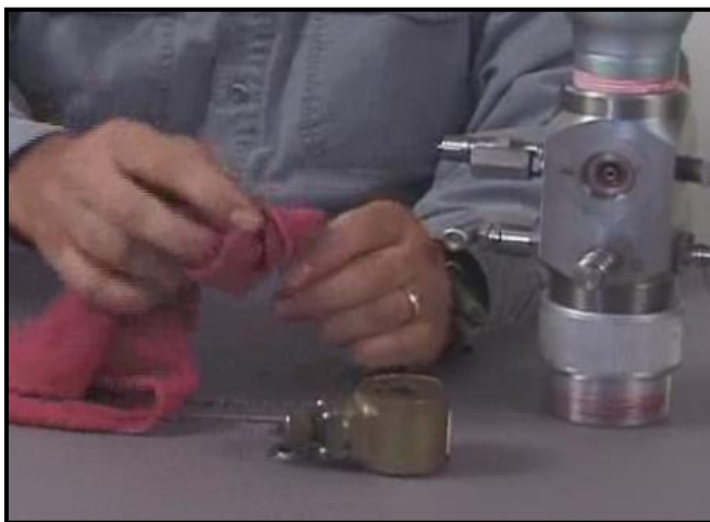
Figura 160. Imagen de la limpieza de la válvula de disparo
