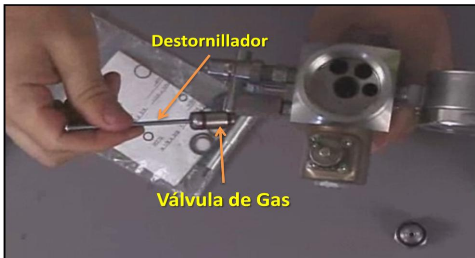
Figura 167. Imagen de la extracción de la válvula de gas
