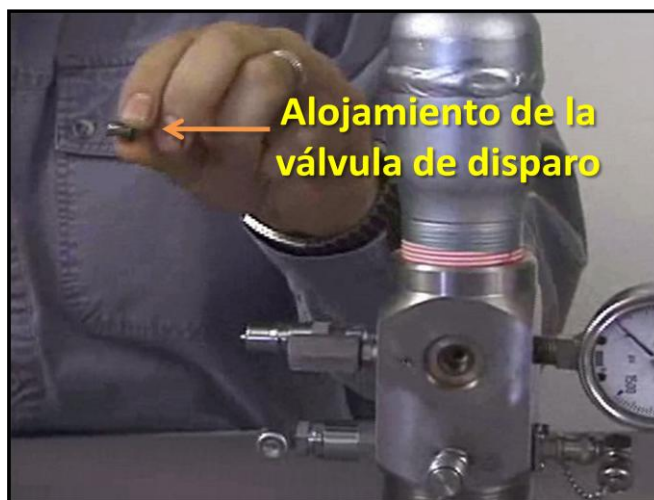
Figura 163. Imagen de la extracción del orificio de alojamiento de la válvula de disparo
