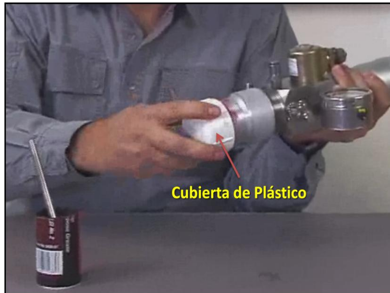
Figura 156. Imagen de la cubierta de plástico en la rosca del Protector del micrófono
