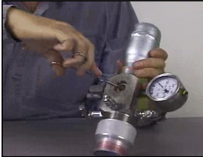
Figura162. Imagen de la extracción de orificio de alojamiento con la ayuda de las pinzas
