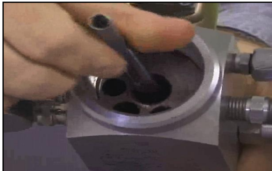
Figura 170. Imagen de la aplicación de lubricante en el orificio de la válvula de gas
