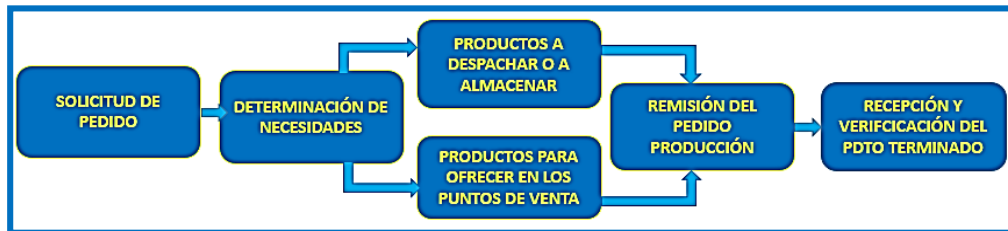
Figura 9. Diagrama de flujo general del proceso de aprovisionamiento de producto terminado en el almacén principal de Carlixplast S.A.S.
