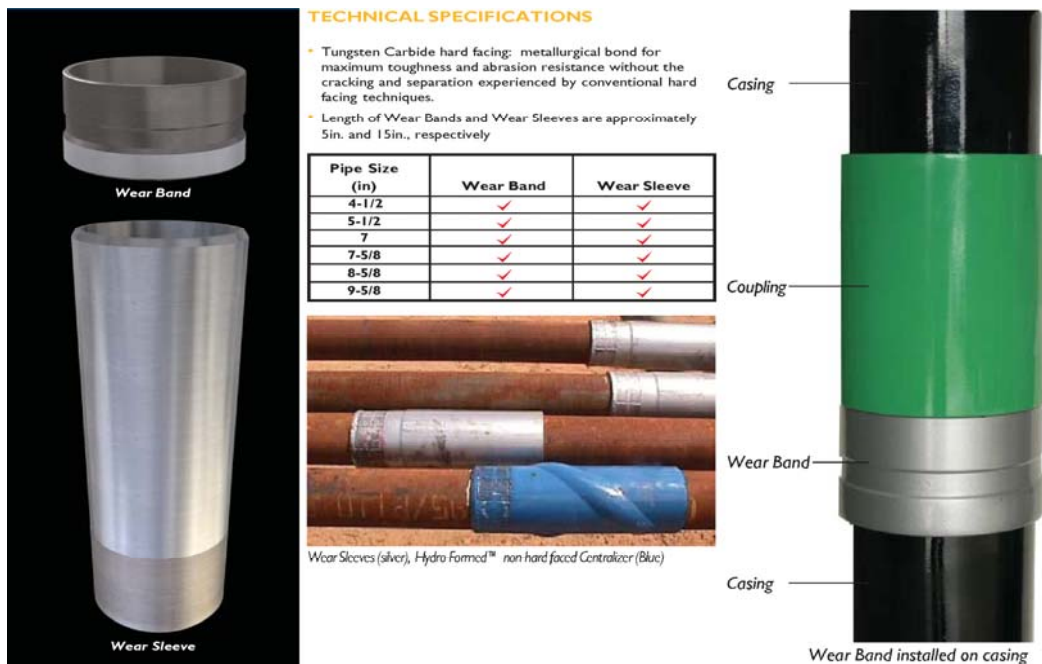
Figura 21. Wear Protection , Wear Band y Wear Sleeves , Especificaciones Técnicas.
