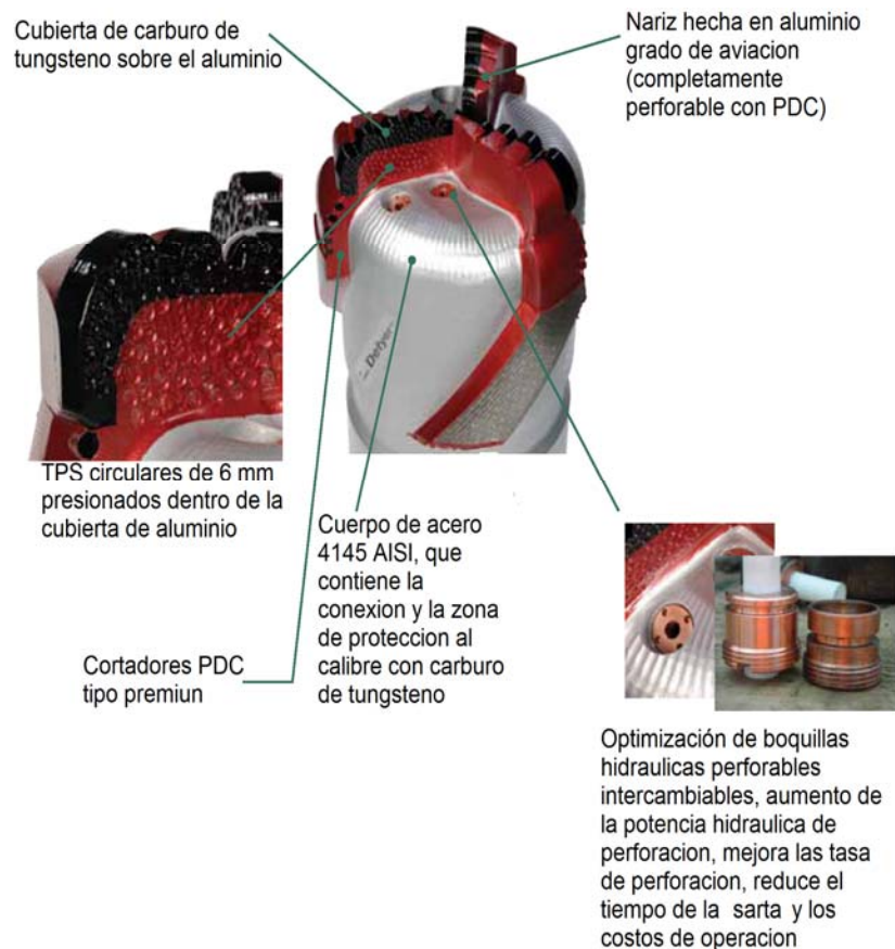
Figura 30. Partes de una DrillShoe .
