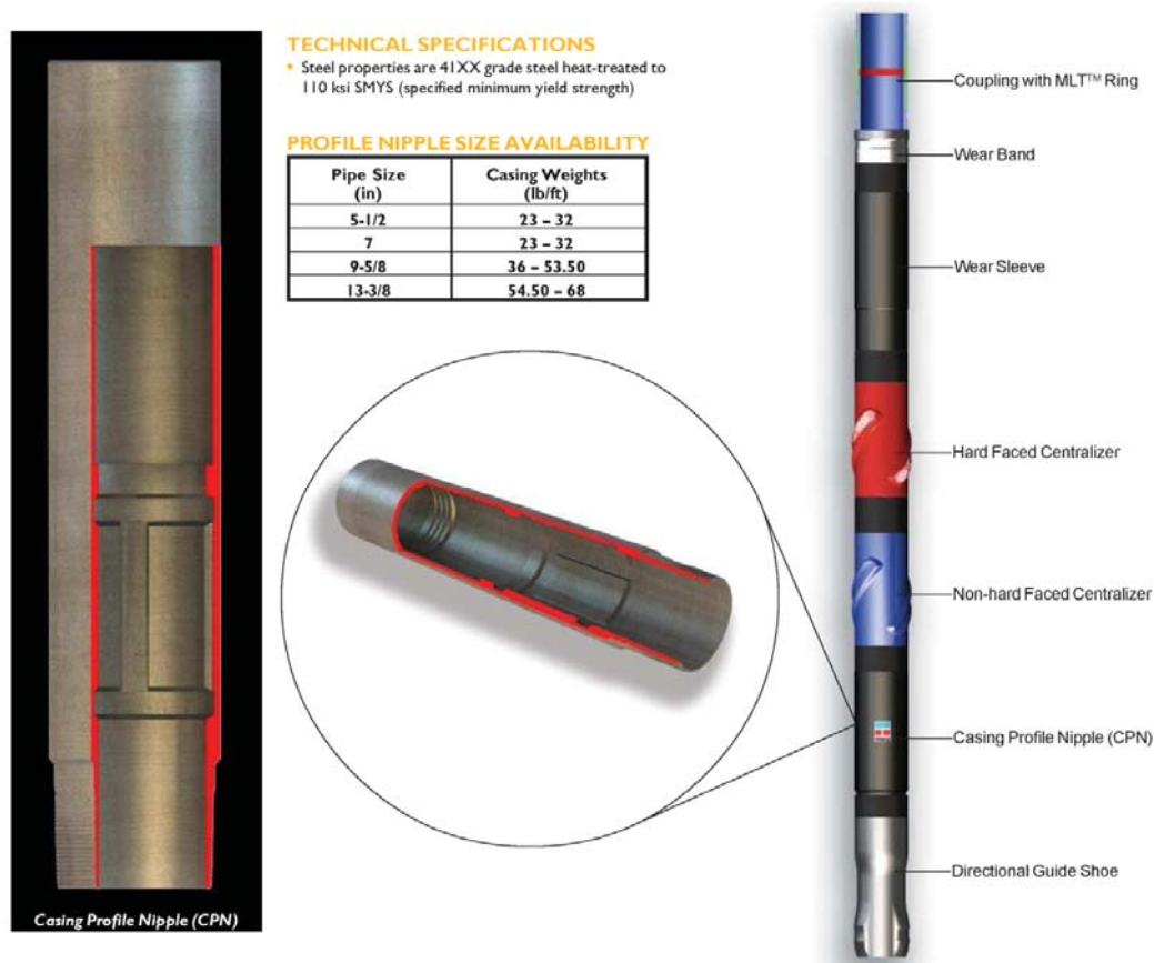
Figura 22. Casing Profile Nipple (CPN) , Especificaciones Técnicas y Tamaños.
