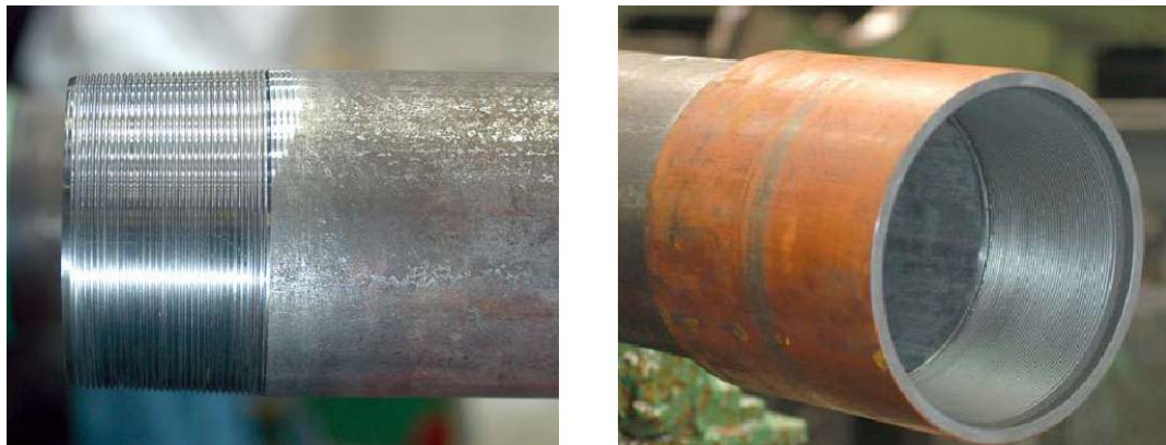
Figura 2. Pin y Caja de 8 HRR (Ocho Hilos Rosca Redonda) sin Recalcar para Casing y Tubing .
