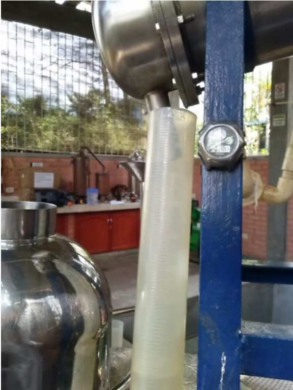
Figura 23. Medición de flujo y de la cantidad de aceite obtenido por minuto.
