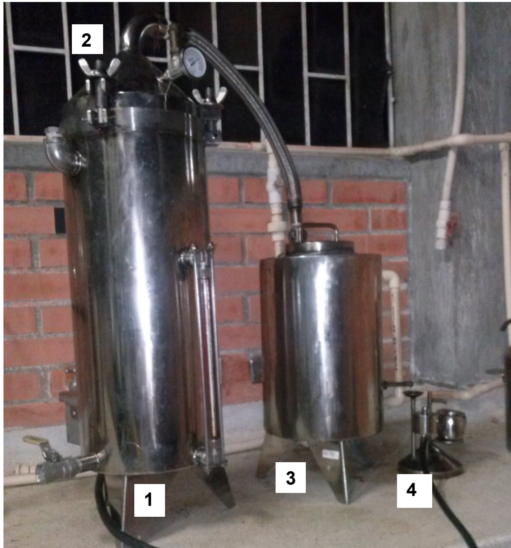
Figura 10. Equipo Tradicional de Hidrodestilación.
