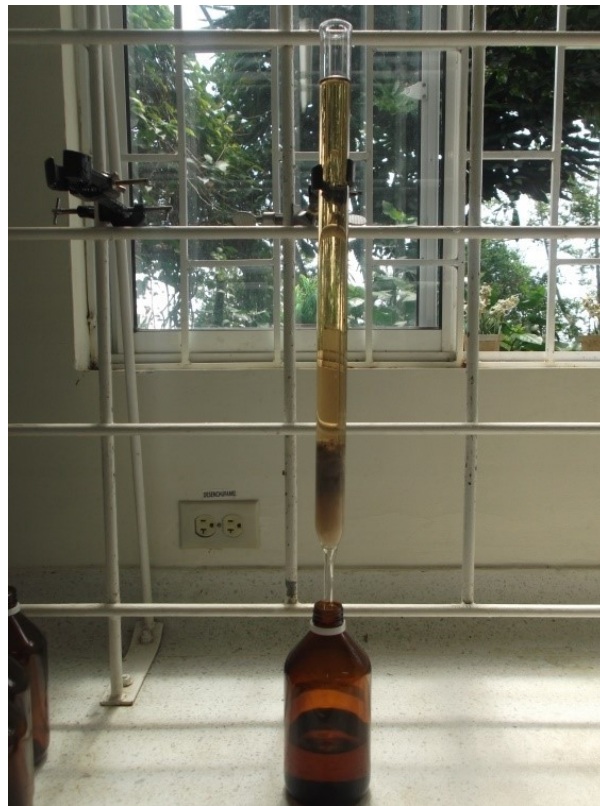
Figura 25. Filtración del aceite con sulfato de sodio anhidro y preparación de muestras para análisis cromatográfico.
