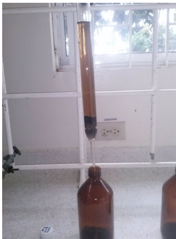
Figura 32. Limpieza y filtrado del aceite con carbón activado y sulfato de sodio anhidro.
