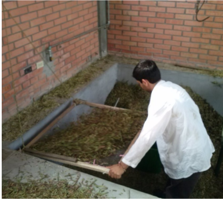
Figura 21. Tamizado del material picado.
