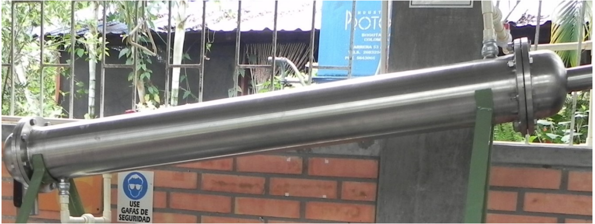
Figura 14. Condensador de tubos y carcasa.
