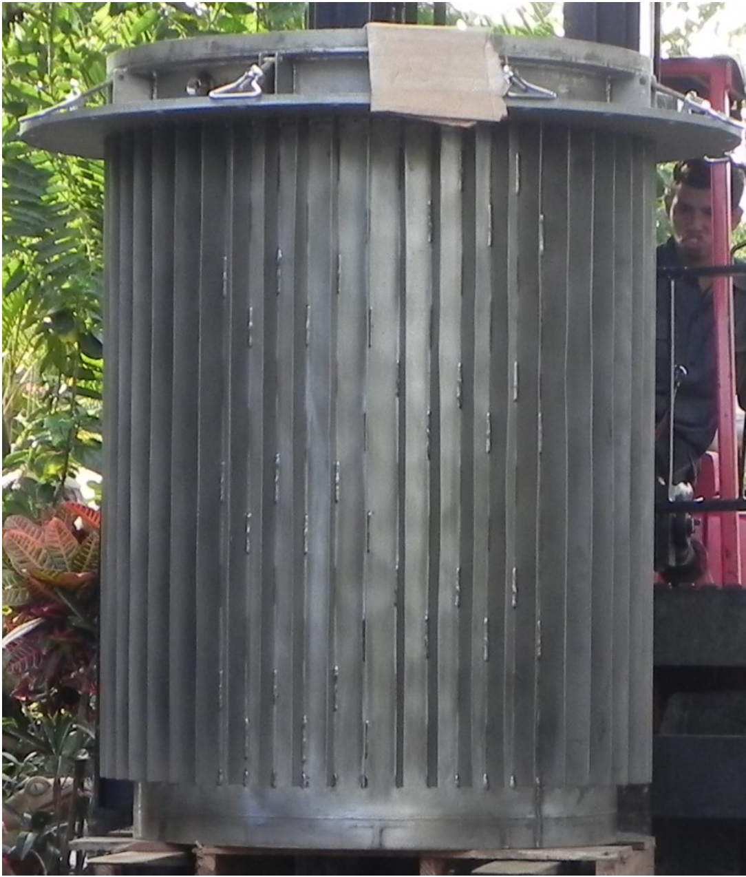
Figura 18. Camisa de gases del alambique.
