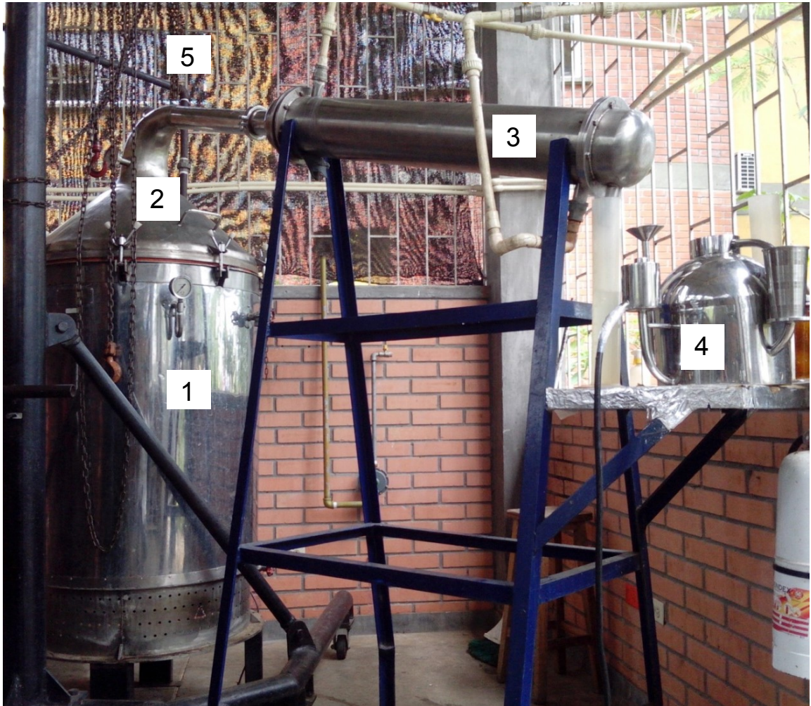
Figura 11 Equipo Tradicional de Destilación por Arrastre con Vapor.
