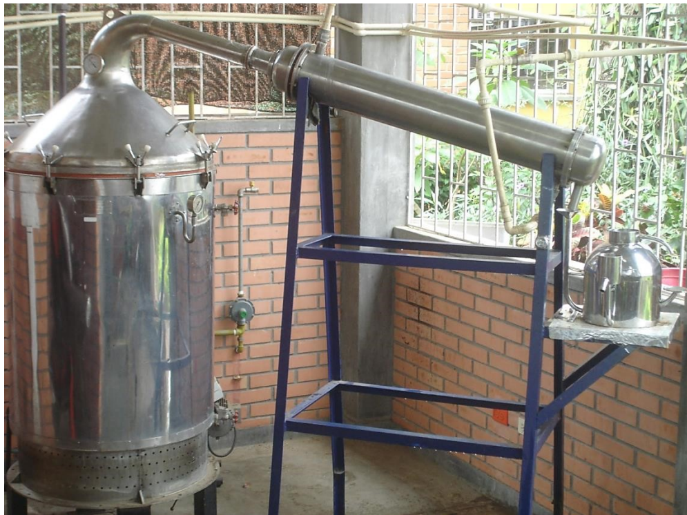
Figura 22. Montaje del equipo utilizado para destilar por arrastre con vapor.
