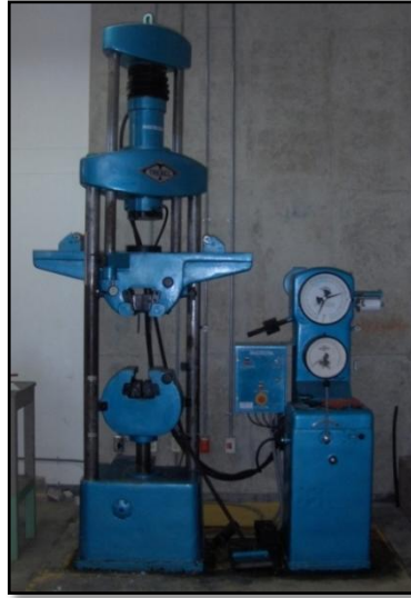
Figura 8: Máquina de Ensayos de concretos, Marca Trebel
