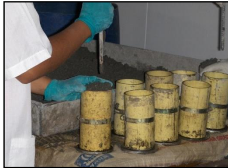
Figura 7: Moldeo de las probetas
