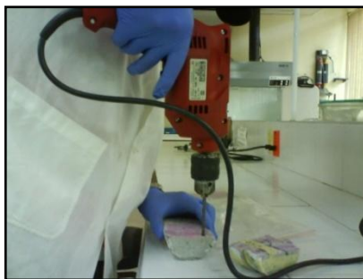
Figura 12: Extracción de muestras para DRX
