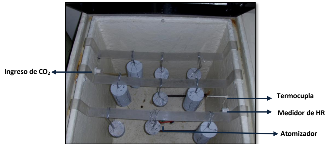
Figura 11: Partes o componentes al interior de la cámara de Carbonatación
