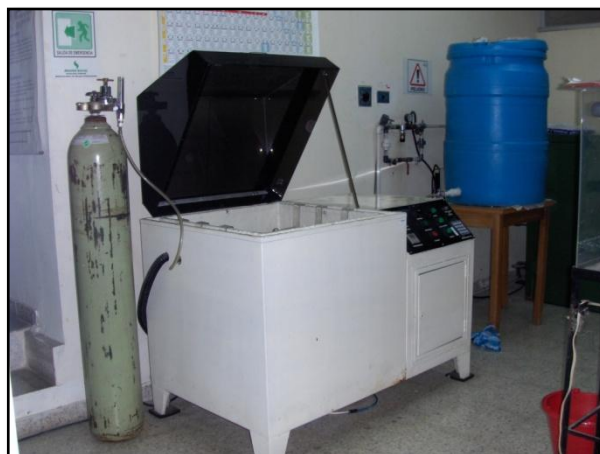
Figura 10: Montaje para la Carbonatación Acelerada
