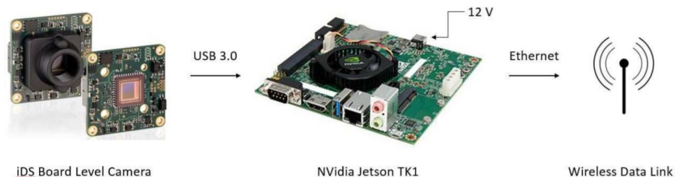
Figura 1. Arquitectura de pipeline para codificación de vídeo a color, incorporado H.264 en tiempo real, para una plataforma de procesamiento móvil [4]
