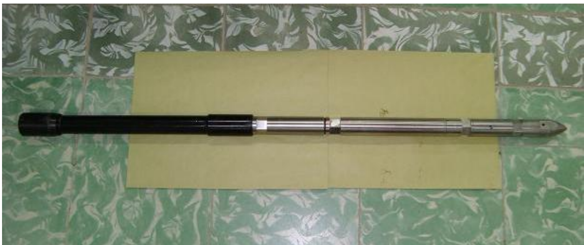
Figura 38. Ensamble, coupling de la bomba de subsuelo acoplada a la memoria registradora de presión mediante la herramienta perforada construida.
