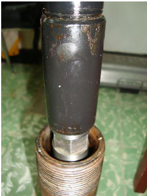
Figura 39 y 40 Verificación de máximo OD del ensamble y mínimo ID de la niplesilla de asentamiento de la bomba.
